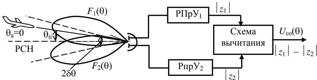
Рис. 6.33. Принцип действия углового измерителя по методу АМС
