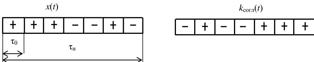
Рис. 4.39. Графическое представление ФМ-сигнала и его импульсной характеристики
