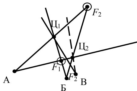
Рис. 7.5. Устранение неоднозначностей при триангуляционном методе:
