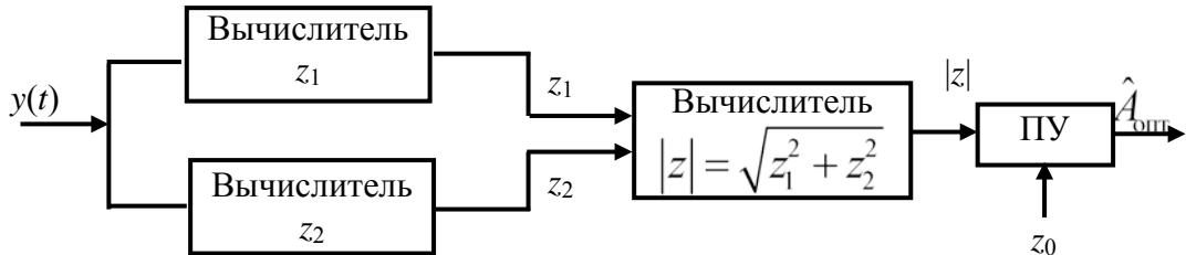
Рис. 3.9. Схема корреляционного обнаружителя с квадратурными каналами
