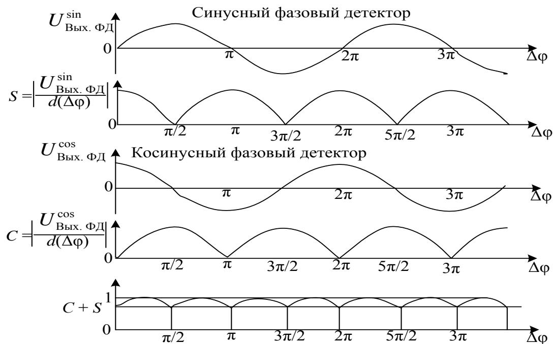
Рис. 4.91. Огибающие сигналов в каналах обработки
