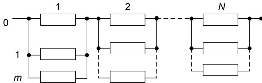
Рис. 8.6. Раздельное резервирование
