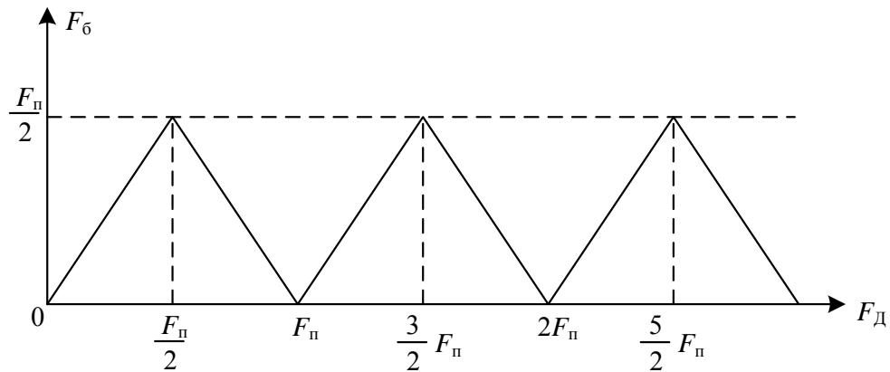
Рис. 4.101. Зависимость частоты огибающей видеоимпульсов от частоты Доплера
