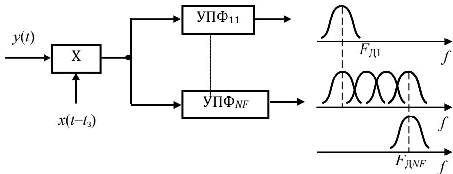
Рис. 4.9. Многоканальный коррелятор с параллельным обзором по скорости
