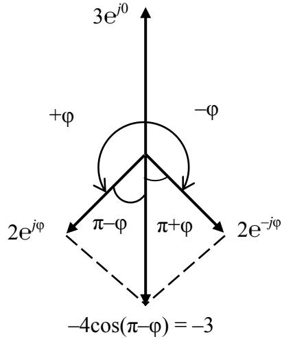
Рис. 5.27. Векторная диаграмма, поясняющая возможность взаимной компенсации напряжений, снимаемых с отводов линии задержки
