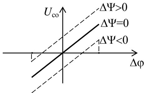
Рис. 6.42. Зависимость  $U_{\text{co}}$  от  $\Delta\varphi$ , поясняющая появление ошибок измерения из-за неидентичности  $\Delta\psi$  фазовых характеристик каналов приёма
