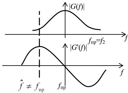
Рис. 6.26. АЧХ фильтров частотного дискриминатора, представленного на рис. 6.25
