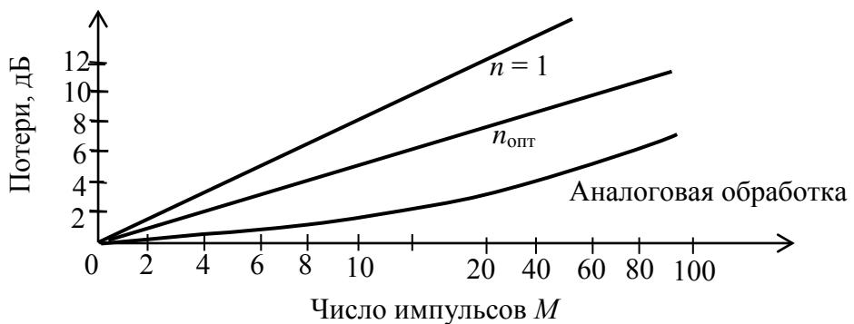
Рис. 3.18. Графики потерь двухуровневого накопления (для случаев:  $n = 1$  и  $n_{\text{опт}} = 1,5\sqrt{k}$ ) и равновесного квадратичного некогерентного накопления (при  $D = 0,9$ ,  $F = 10^{-7}$ ) по сравнению с когерентным
