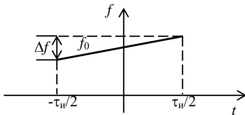
Рис. 5.17. Закон изменения частоты
