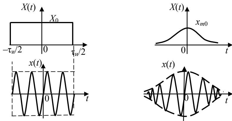
Рис. 2.2. Законы модуляции и вид прямоугольного
