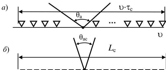
Рис. 5.31. Образование синтезированной антенны
