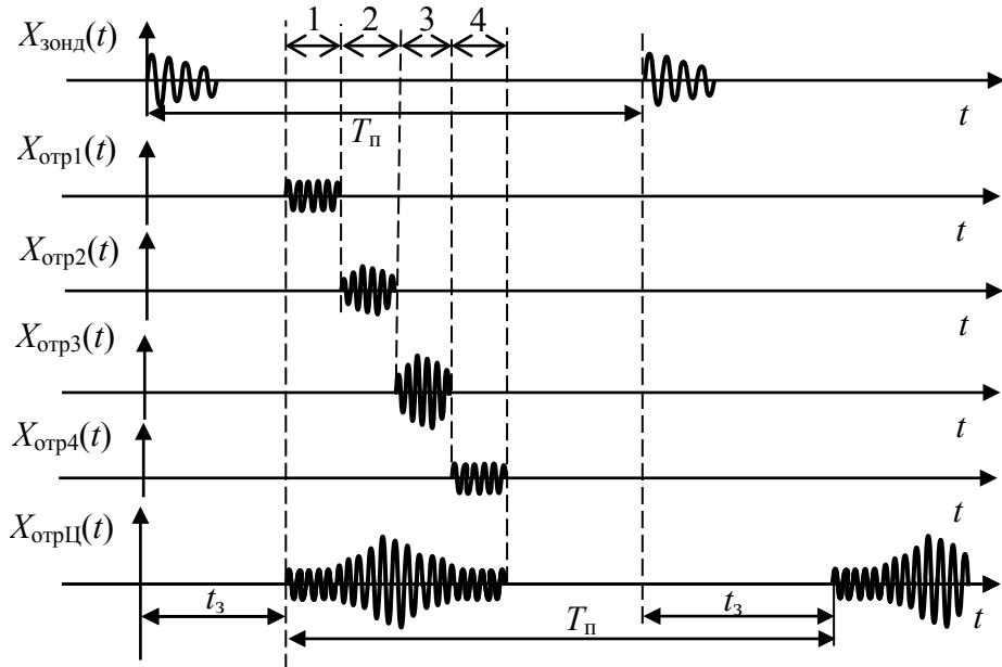
Рис. 2.33. Процесс формирования отраженного сигнала от мешающих отражателей
