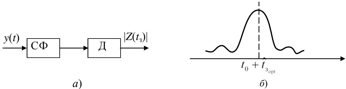
Рис. 6.12. Оценка времени запаздывания при использовании фильтровой схемы с амплитудным детектором (*a*); вид огибающей на выходе согласованного фильтра (*б*), здесь  $t_0$  – время задержки в фильтре
