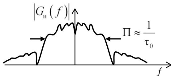
Рис. 5.24. Спектр ФМ-сигнала
