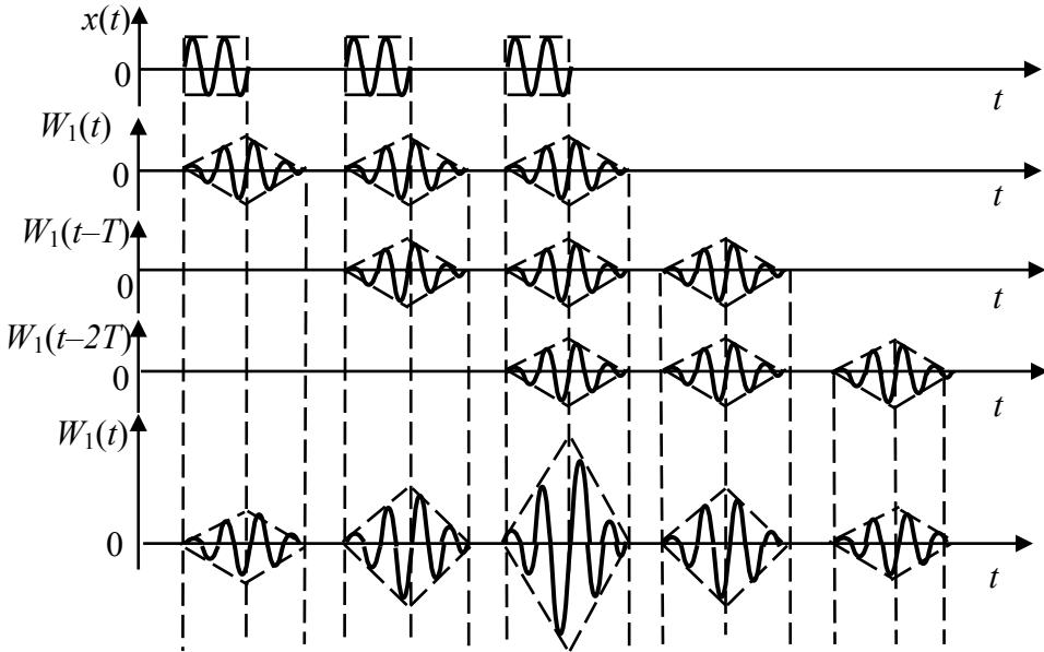
Рис. 4.29. Результат фильтрации прямоугольной пачки из  $M = 3$  радиоимпульсам
