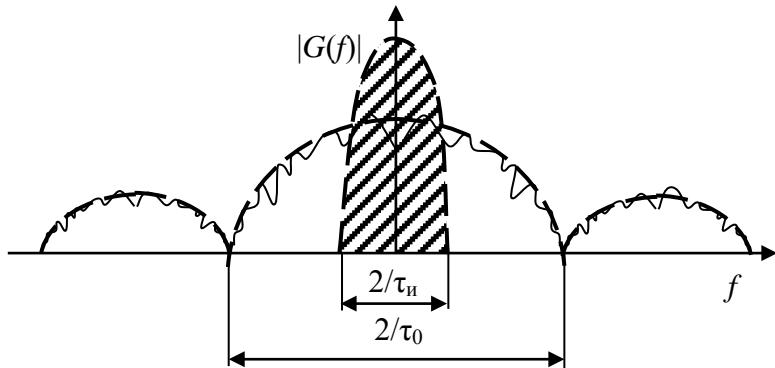
Рис. 4.37. Спектр ФМ-сигнала
