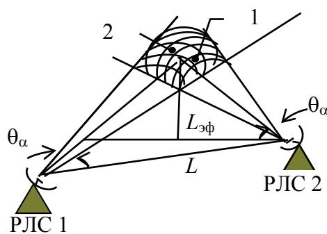
Рис. 7.3. Иллюстрация повышения разрешающей способности МП РЛС
