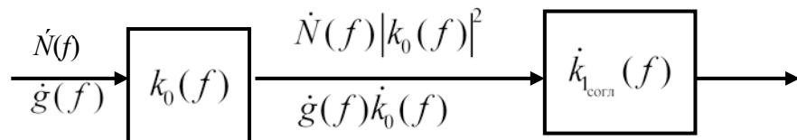
Рис. 4.69. Схема фильтрации на фоне белого шума
