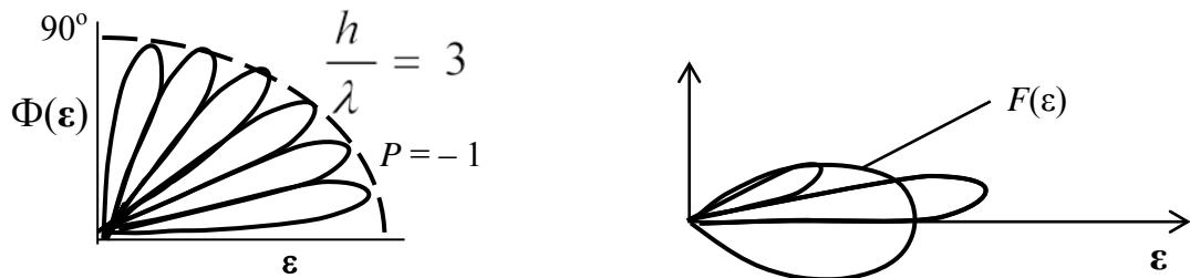
Рис. 3.25. Характер изменения множителя Земли в зависимости от высоты антенны  $h$  и длины волны  $\lambda$
