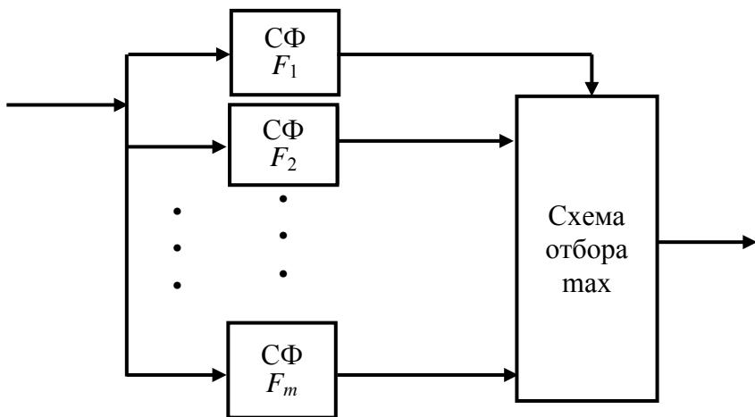
Рис. 4.19. Схема обнаружителя для выделения сигналов от целей, движущихся с различными скоростями
