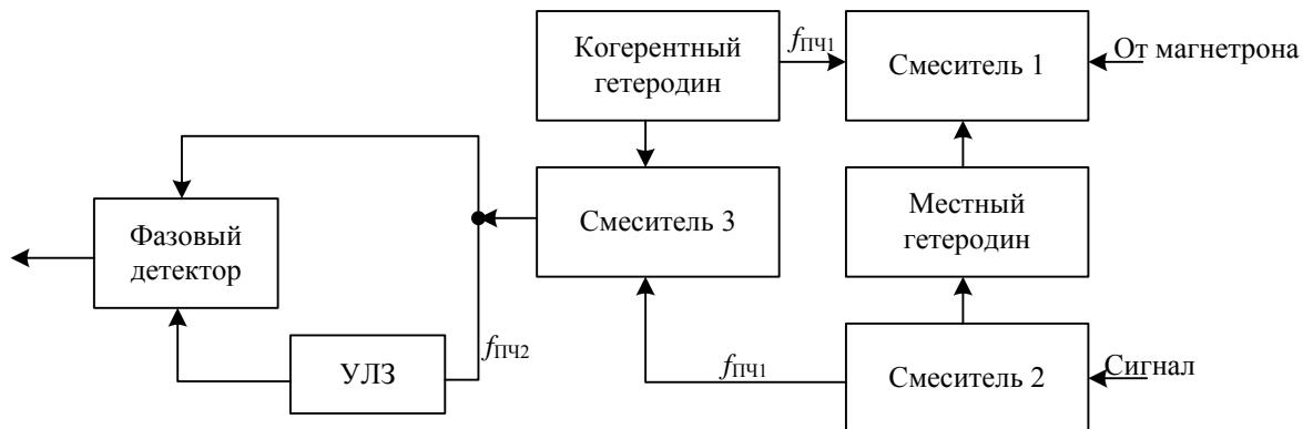
Рис. 4.92. Подавитель на промежуточной частоте
