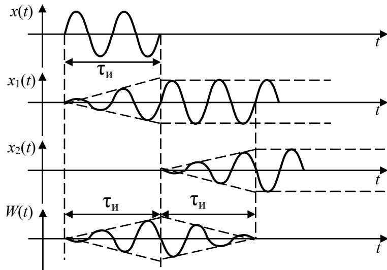
Рис. 4.24. Процесс формирования сигнала на выходе СФ
