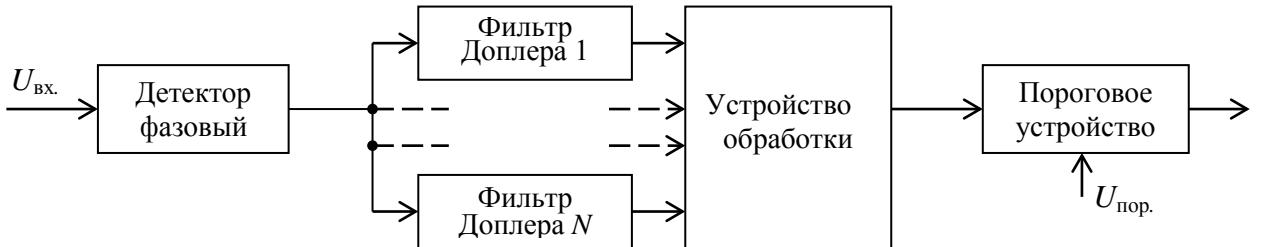
Рис. 6.51. Устройство распознавания по частоте Доплера
