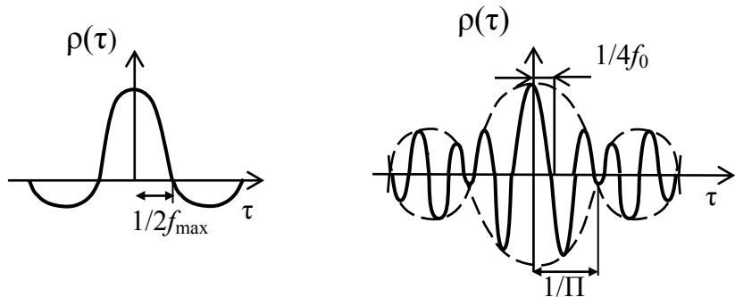
Рис. 2.29. Нормированные корреляционные функции квазибелого шума
