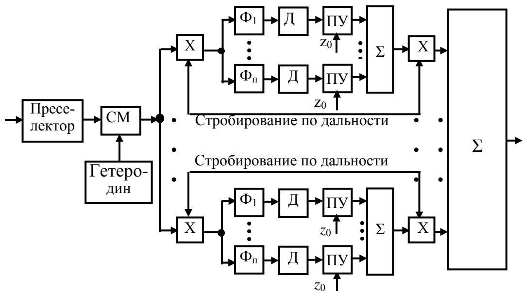
Рис. 4.59. Схема многоканального корреляционно-фильтрового обнаружителя:
