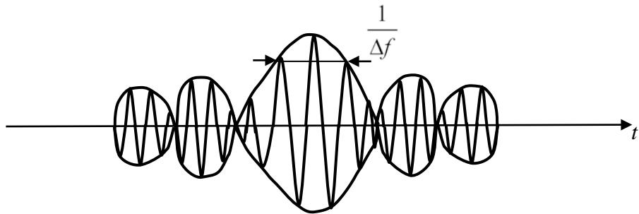
Рис. 4.49. Вид сжатого импульса на выходе согласованного фильтра
