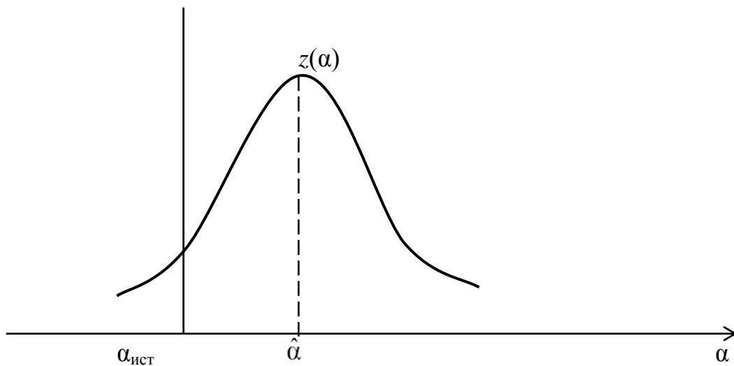
Рис. 6.19. Отклик оптимального фильтра на воздействие полезного сигнала с шумом
