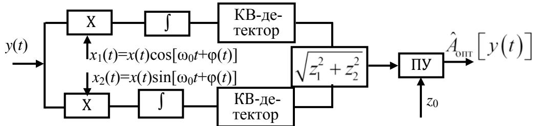
Рис. 4.4. Схема корреляционного обнаружителя с двумя квадратурными каналами
