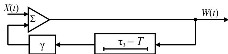
Рис. 4.32. Структурная схема рециркулятора
