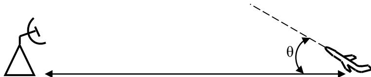
Рис. 2.14. Зависимость величины ЭПР от угла поворота цели относительно направления на РЛС
