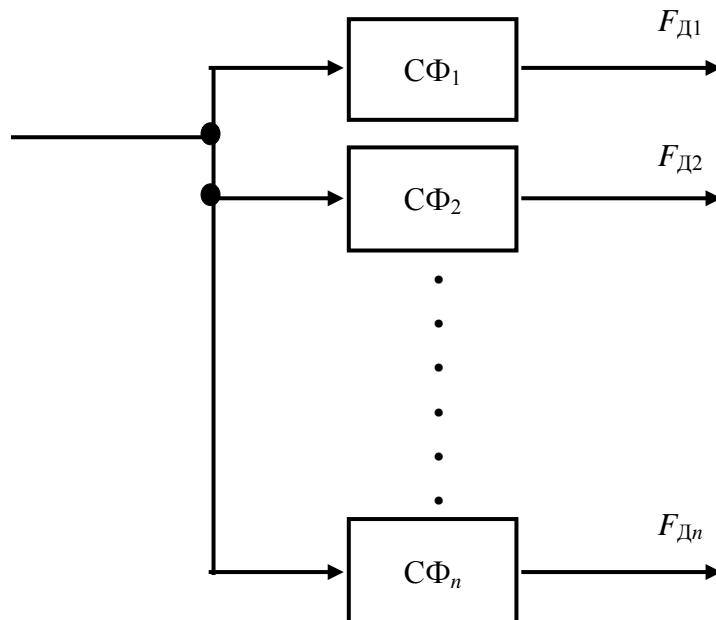
Рис. 4.33. Фильтровая схема обработки сигналов большой длительности
