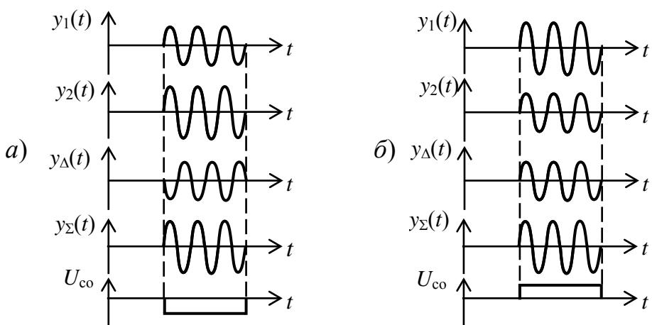
Рис. 6.38. Зависимость амплитуды разностного сигнала  $U_{co}$  от величины углового рассогласования  $\Delta\theta = \theta_{ц} - \theta_a$
