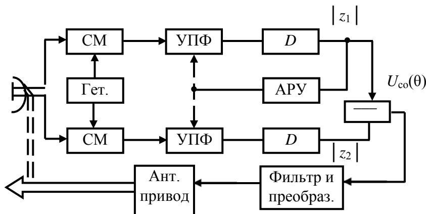
Рис. 6.35. Схема амплитудного пеленгатора
