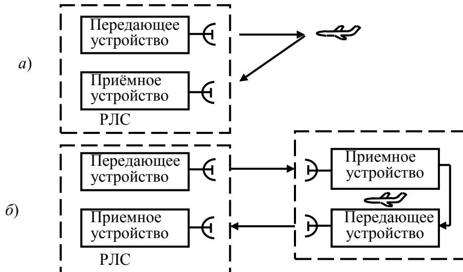
Рис. 1.1. Виды радиолокации: *а* – активная с пассивным ответом;
