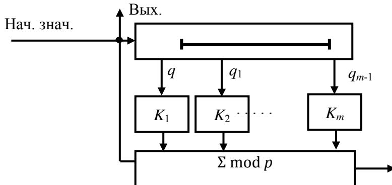
Рис. 4.36. Схема формирования  $M$ -кодов
