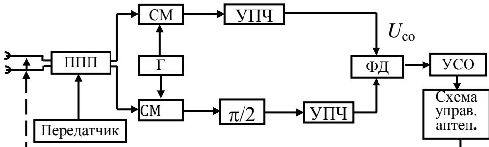
Рис. 6.41. Типовая схема следящего измерителя угловых координат, реализующая метод ФМС сигналов
