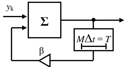
Ненулевые дискреты ИХ  $v_0 = 1$ ,  $v_M = \beta$ ,  $v_{2M} = \beta^2$  и т. д. АЧХ имеет гребни накопления.
