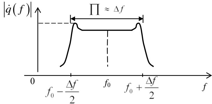
Рис. 4.47. Спектр прямоугольного ЛЧМ-радиоимпульса
