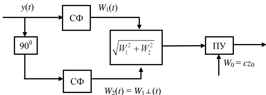
Рис. 4.18. Фильтровый обнаружитель для сигналов со случайными параметрами
