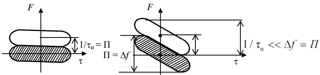
Рис. 5.20. Разрешение широкополосных сигналов с перекрывающимися спектрами
