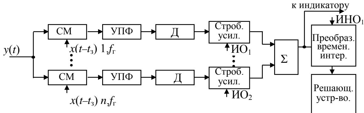
Рис. 6.11. Измеритель времени запаздывания при корреляционно-фильтровом методе обработки радиолокационных сигналов
