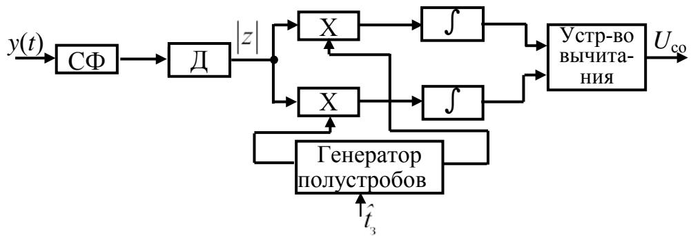
Рис. 6.14. Временной дискриминатор на основе фильтрового устройства обработки
