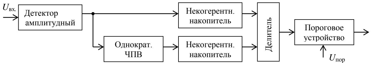
Рис. 6.49. Устройство распознавания по величине амплитудных флюктуаций импульсов пачки
