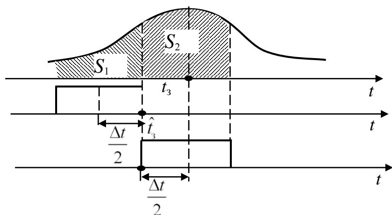
Рис. 6.15. Формирование разностного сигнала  $U_{co}$  с помощью полустробов автосопровождения
