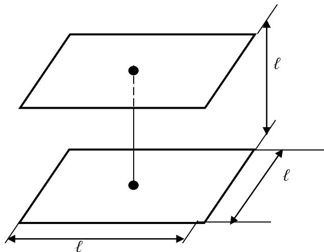
Рис. 2.15. Модель элементарного вибратора с емкостным сопротивлением
