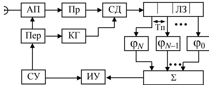
Рис. 5.32. Структурная схема РЛС с синтезированным раскрывом
