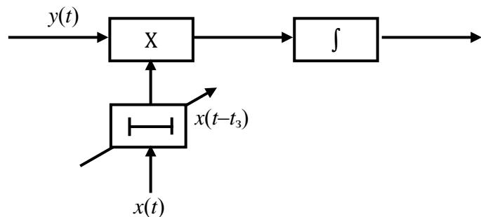
Рис. 4.6. Одноканальный коррелятор с последовательным обзором по дальности
