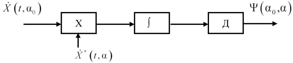
Рис. 5.4. Схема получения функции рассогласования по виду корреляционного интеграла
