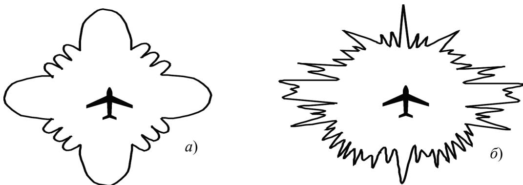
Рис. 2.23. Диаграммы обратного вторичного излучения самолета при облучении его ЗС:
