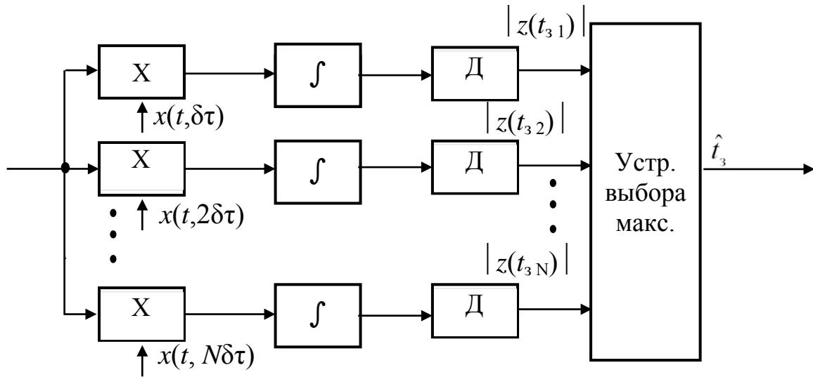
Рис. 6.10. Упрощенная схема обзорного корреляционно-фильтрового измерителя времени запаздывания
