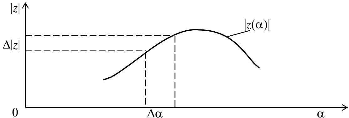
Рис. 6.9. Вычисление производных корреляционного интеграла через приращения
