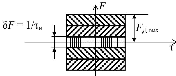
Рис. 5.12. К определению количества частотных каналов, необходимых для обработки импульса данной длительности в диапазоне доплеровских частот  $F_{D \max}$
