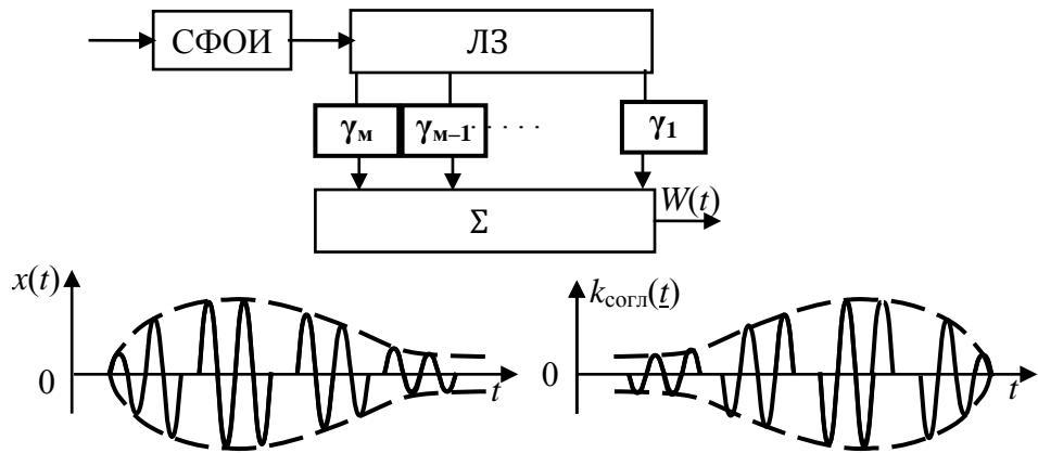
Рис. 4.31.Структурная схема СФ прямоугольной пачки с весовым суммированием
