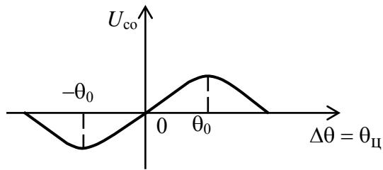
Рис. 6.40. Дискриминационная характеристика пеленгатора ФМС
