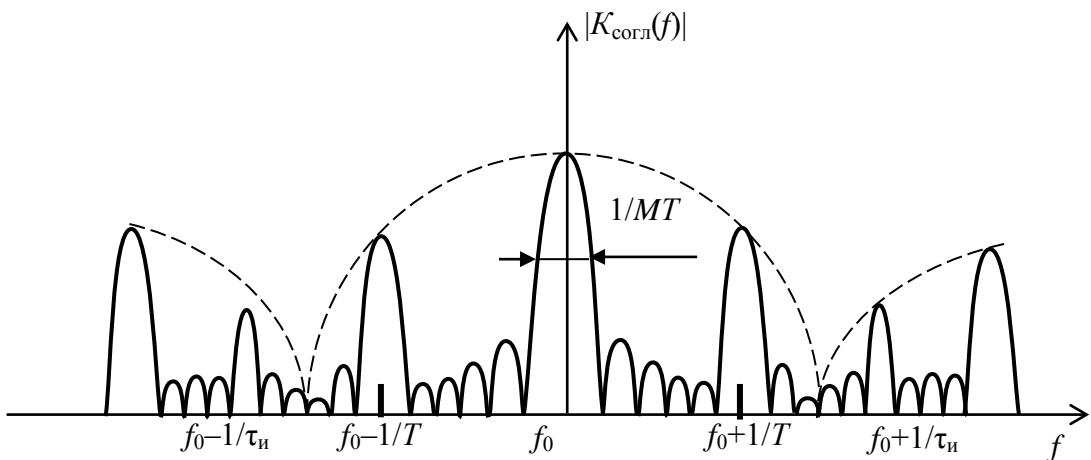
Рис. 4.30. АЧХ согласованного фильтра прямоугольной пачки радиоимпульсов
