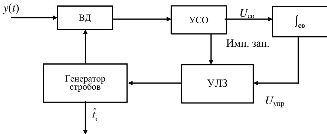
Рис. 6.16. Упрощенная структурная схема следящего измерителя дальности: ВД – временной дискриминатор, предназначенный для формирования сигнала ошибки; УСО – усилитель сигнала ошибки;  $\int_{\text{co}}$  – интегратор сигнала ошибки; УЛЗ – управляемая линия задержки
