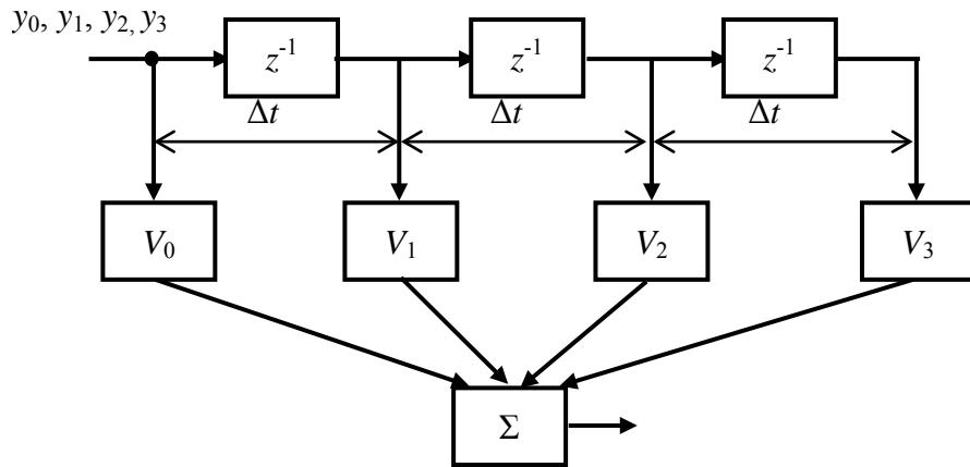
Рис. 4.116. Структурная схема нерекурсивного фильтра для обработки сигнала, состоящего из четырех временных дискрет,  $z^{-1}$  – элемент задержки на тakt  $\Delta t$
