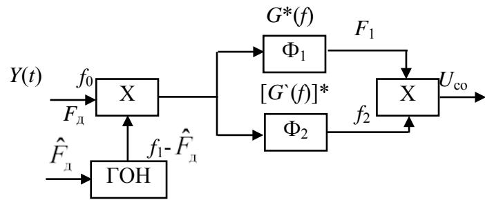
Рис. 6.25. Функциональная схема частотного дискриминатора с фазовым детектированием
