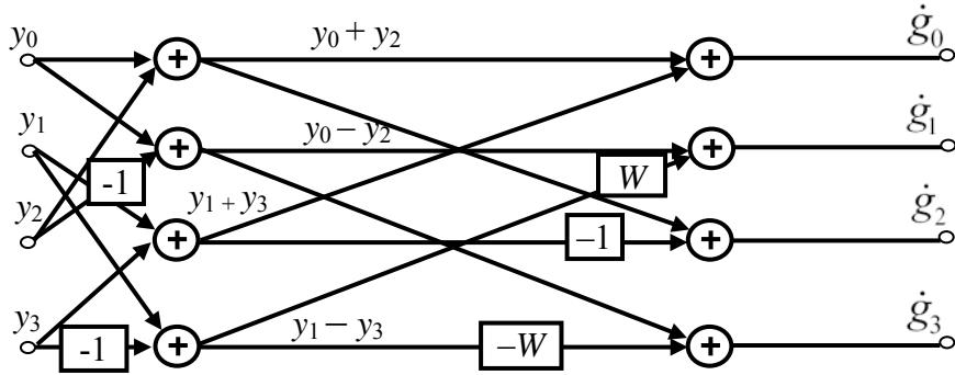
Рис. 4.121. Схема графа для четырехточечного ДПФ
