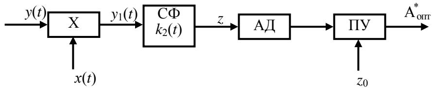
Рис. 4.52. Структурная схема корреляционно-фильтрового обнаружителя:
