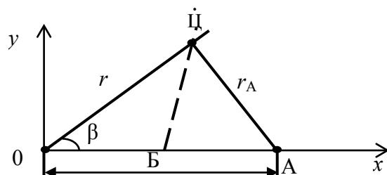
Рис. 7.7. Пояснение угломерно-разностно-дальномерного метода определения координат на плоскости
