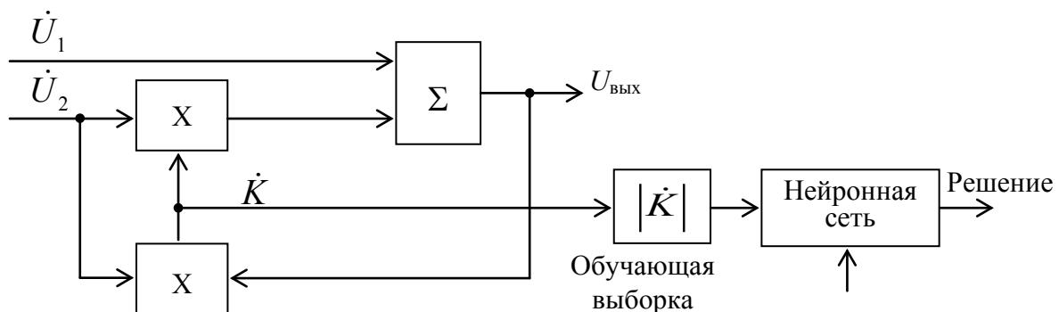
Рис. 6.52. Устройство распознавания по корреляционному признаку
