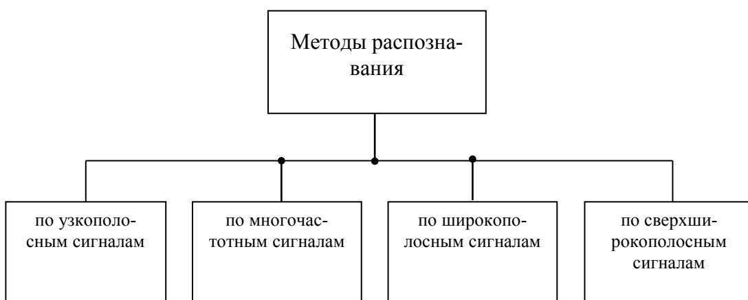
Рис. 6.45. Методы распознавания по типу зондирующего сигнала
