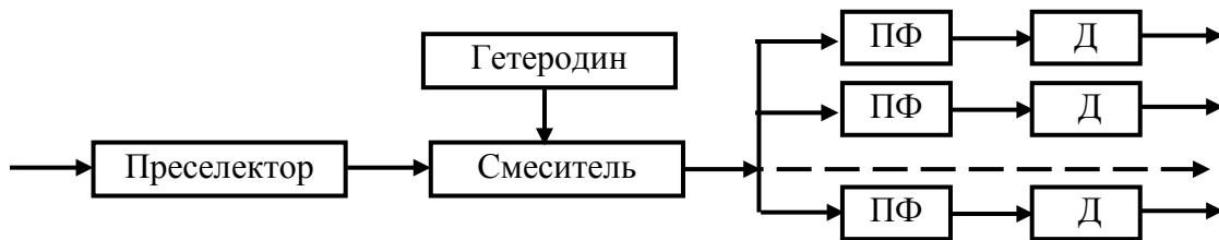
Рис. 4.57. Схема выделения колебаний разностной частоты с помощью спектроанализатора
