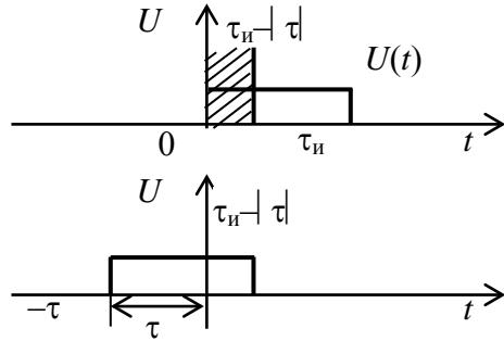
Рис. 5.18. Определение пределов интегрирования для вычисления АКФ ЛЧМ-сигнала
