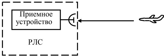
Рис. 1.3. Пассивная радиолокация
