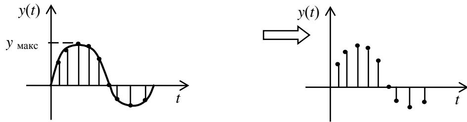
Рис. 4.113. Дискретизация входного сигнала
