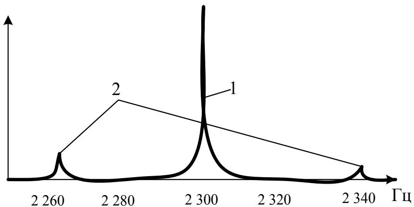
Рис. 6.50. Спектр доплеровских частот, обусловленный отражением от самолета (1) и коническим сканированием антенны РЛС (2)
