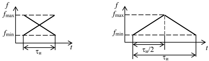
Рис. 5.21. Пример устранения неопределенности «дальность – скорость» при использовании двух ЛЧМ-радиоимпульсов, имеющих противоположные законы изменения частоты
