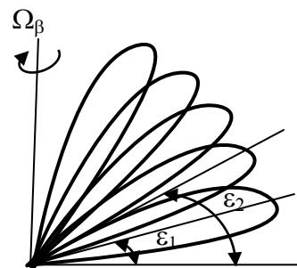
Рис. 1.7. Последовательно-параллельный обзор многоканальной антенной
