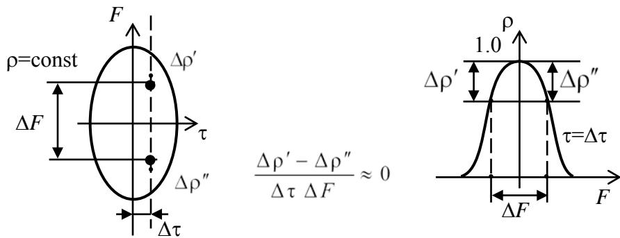
Рис. 6.28. Вид функции рассогласования в отсутствие корреляции ошибок измерения
