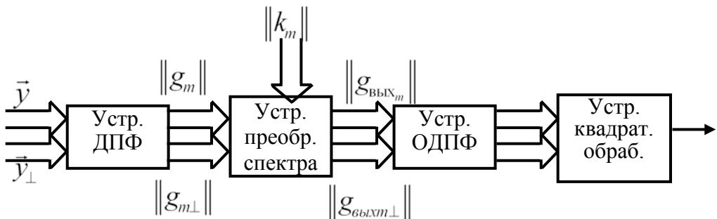
Рис. 4.120. Схема алгоритма обработки дискретного сигнала на основе ДПФ и ОДПФ
