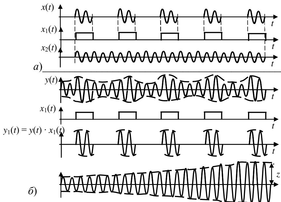
Рис. 4.54. Представление когерентной пачки радиоимпульсов произведением двух функций (a) и временные диаграммы напряжений (б) в схеме, показанной на рис. 4.53
