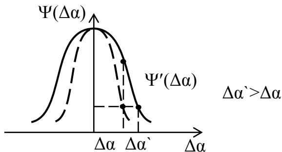
Рис. 5.2. Улучшение разрешения по виду АКФ
