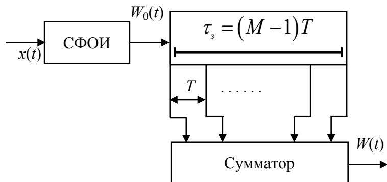
Рис. 4.28. Согласованный фильтр для прямоугольной пачки радиоимпульсов
