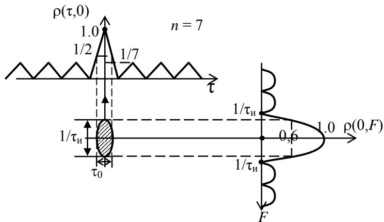
Рис. 5.25. Сечения АКФ для ФМ-сигнала семиэлементного кода Баркера
