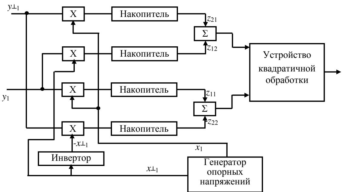
Рис. 4.115. Схема цифрового коррелятора
