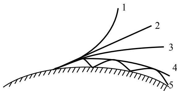
Рис. 3.20. Траектории распространения радиоволн
