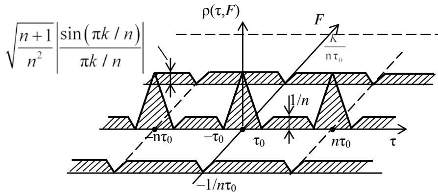
Рис. 5.26. Структура АКФ, фазоманипулированного  $M$ -кодом непрерывного сигнала
