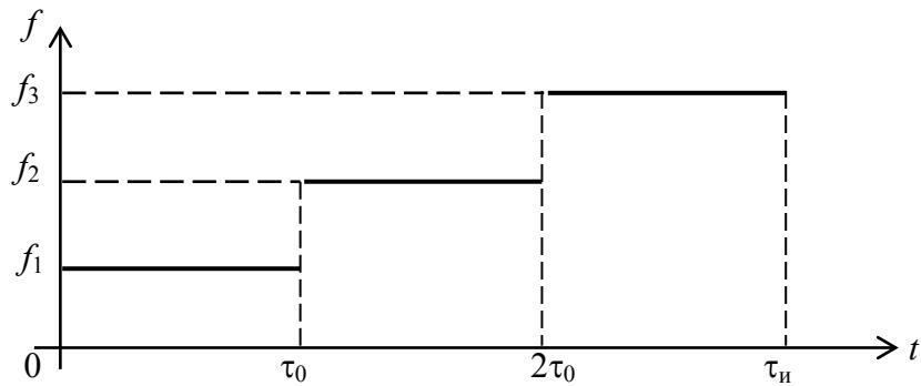
Рис. 2.10. Закон изменения частоты при частотной манипуляции
