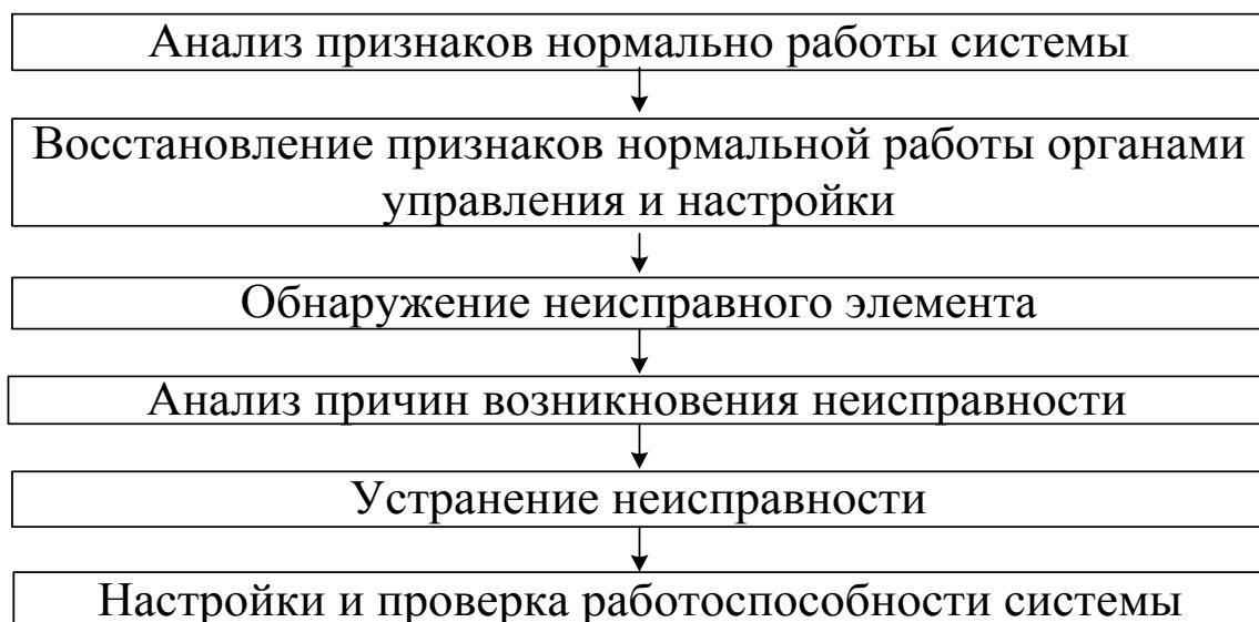
Рис. 8.7. Порядок поиска неисправности в общем случае
