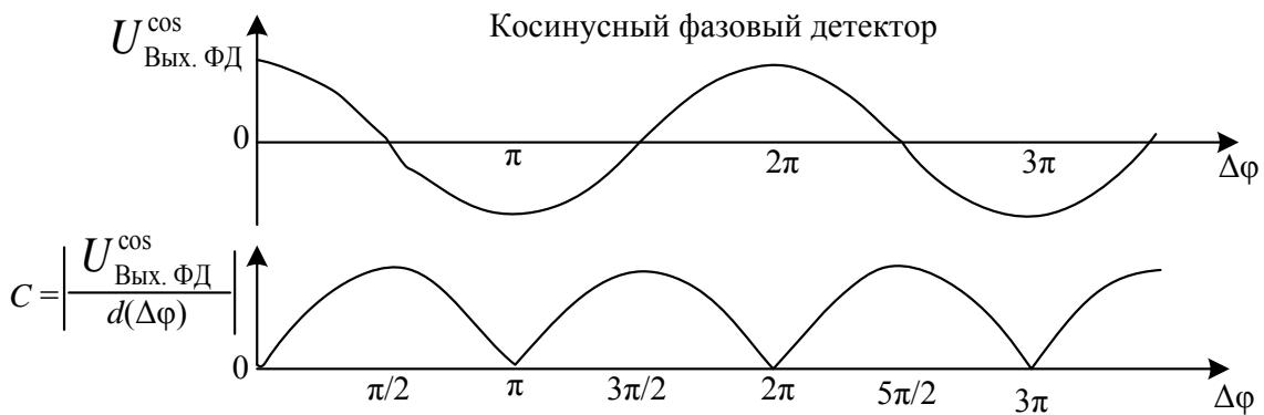
Рис. 4.88. Характеристика ФД и его чувствительности
