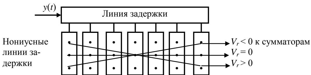
Рис. 4.34. Схема оптимальной обработки семиэлементного ФМ-сигнала на линиях задержки
