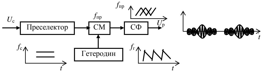
Рис. 4.58. Схема корреляционно-фильтровой обработки с использованием ЛЧМ-гетеродинирования и сжатия в согласованном дисперсионном фильтре
