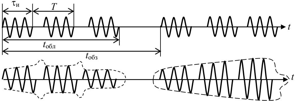
Рис. 2.27. Флюктуации амплитуд импульсов пачки при отражении от движущейся цели
