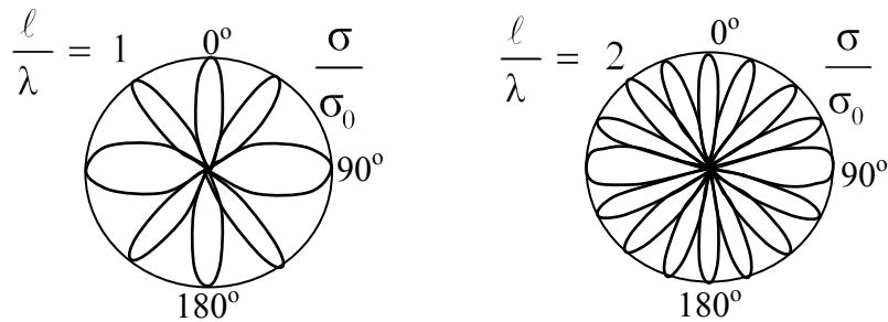
Рис. 2.22. Диаграммы обратного вторичного излучения группового излучателя
