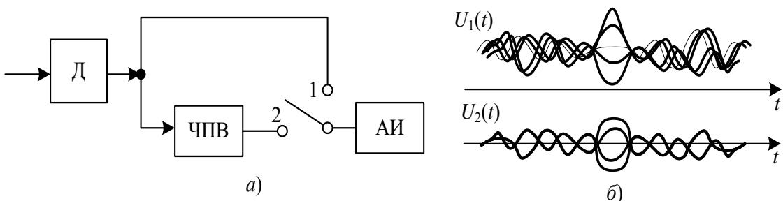
Рис. 4.84. Блок-схема радиолокатора с внешней когерентностью (а) и эпюры, поясняющие его работу (б)
