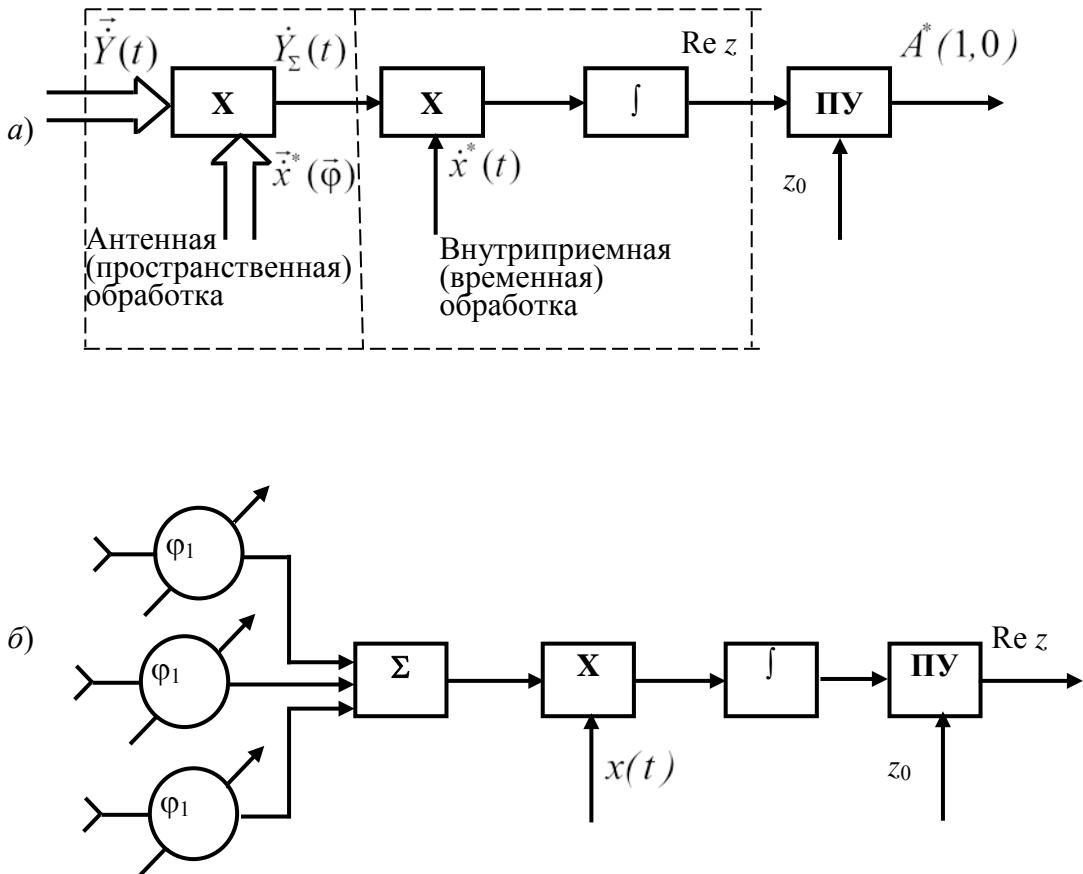
Рис. 4.106. Структурная схема обнаружителя без детализации (a) и с детализацией (б) антенной обработки
