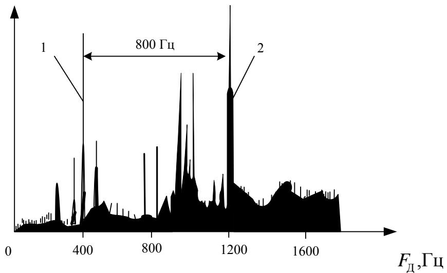
Рис. 6.48. Спектр, вызываемый «пропеллерной» модуляцией (1) и отражениями от корпуса самолета (2)
