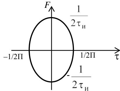
Рис. 5.9. Диаграмма неопределенности импульсного сигнала
