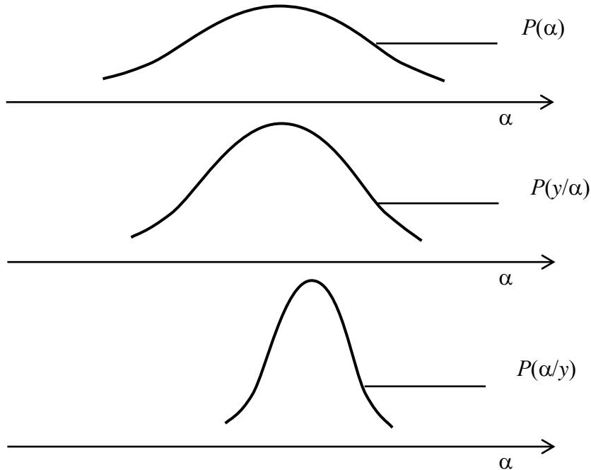
Рис. 6.1. Уточнение апостериорной плотности вероятности измеряемого параметра  $P(\alpha/y)$  по результатам наблюдения реализации  $y$
