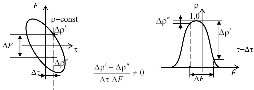
Рис. 6.29. Вид функции рассогласования при наличии корреляции ошибок измерения
