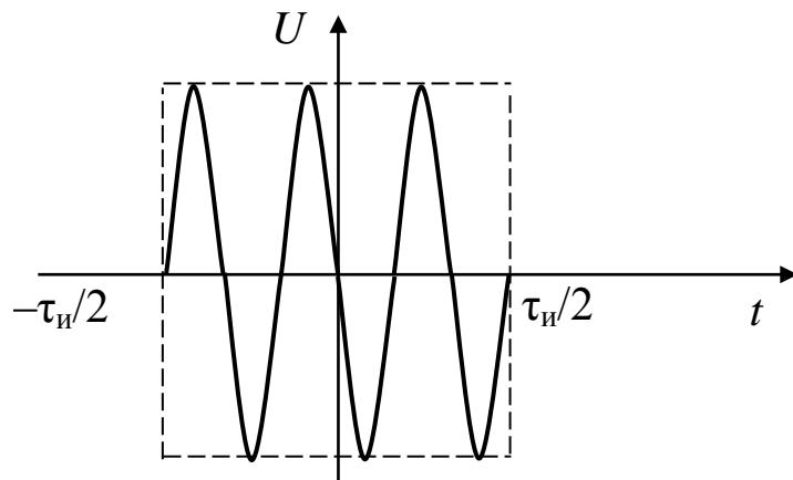
Рис. 5.10. Вид одиночного прямоугольного радиоимпульса
