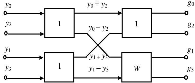
Рис. 4.123. Структурная схема спецпроцессора БПФ на «бабочках»
