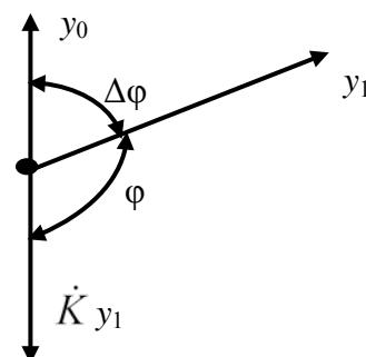
Рис. 4.110. Векторная диаграмма, поясняющая принцип компенсации помехи в схеме, приведенной на рис. 4.109
