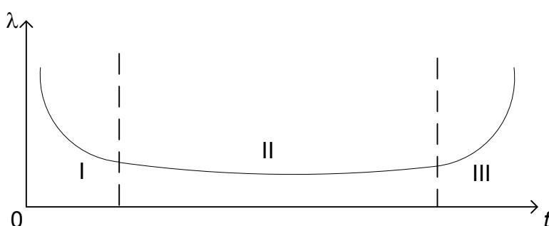
Рис. 8.3. Характеристика интенсивности отказов
