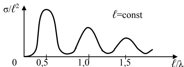
Рис. 2.17. Зависимость  $\sigma$  от величины  $\ell/\lambda$  для полуволнового вибратора
