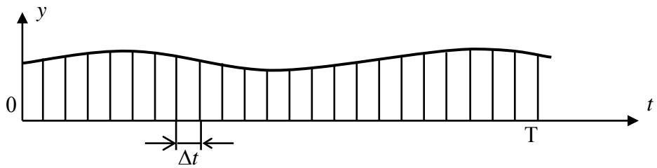
Рис. 4.118. Дискретизация входного сигнала по теореме Котельникова
