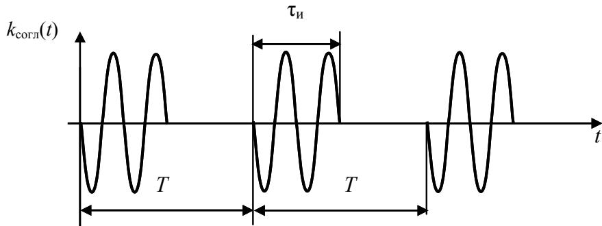
Рис. 4.27. Импульсная характеристика фильтра
