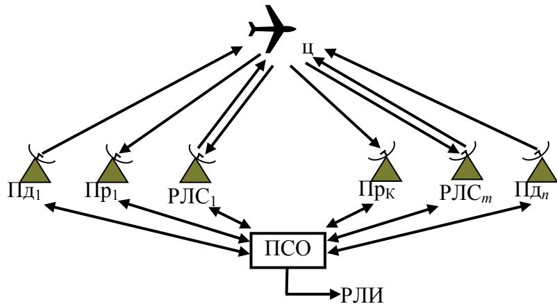
Рис. 7.1. Многопозиционная радиолокационная система
