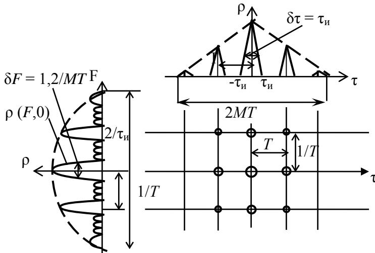
Рис. 5.15. Сечения тела и диаграмма неопределенности когерентной пачки прямоугольных радиоимпульсов
