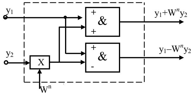
Рис. 4.122. Функциональная схема типовой серийной микросхемы, выполняющей операции четырехточечного БПФ «бабочки» и ее условное обозначение
