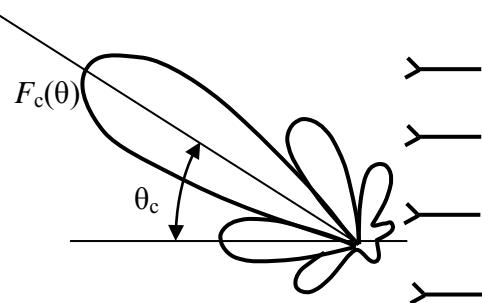
Рис. 4.105. Ориентация диаграммы направленности ФАР в направлении на источник полезного сигнала
