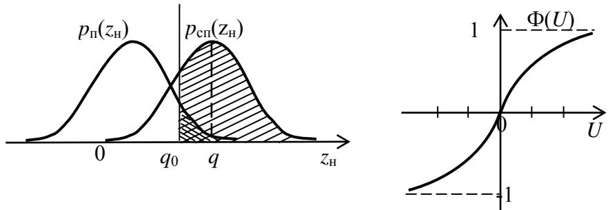
Рис. 3.7. Графики плотности распределений  $p_{\text{п}}(z_h)$ ,  $p_{\text{сн}}(z_h)$  и интеграла вероятности
