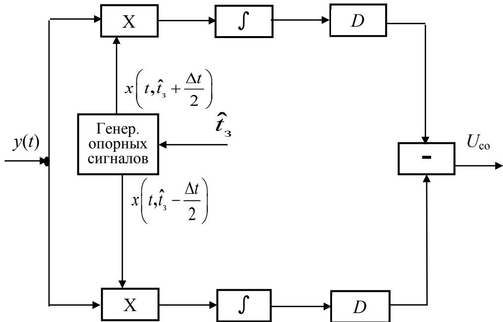
Рис. 6.13. Временной дискриминатор на основе корреляционно-фильтровой схемы
