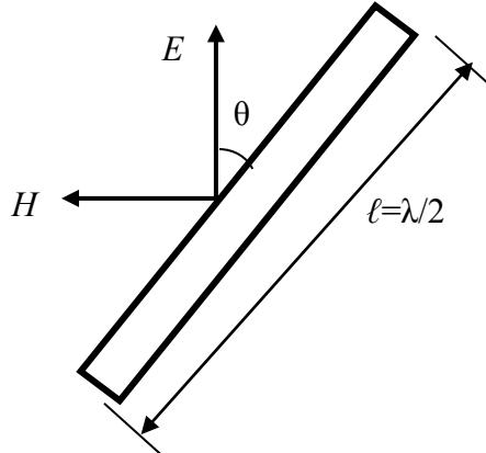
Рис. 2.16. Модель полуволнового вибратора
