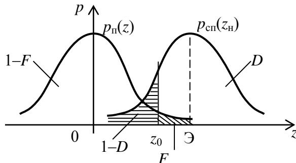
Рис. 3.6. Кривые плотности распределений для полезного сигнала и помехи
