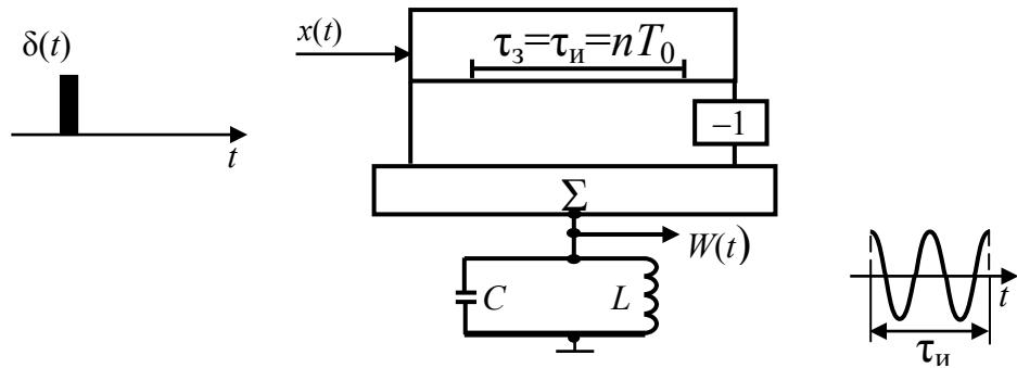
Рис. 4.23. Согласованный фильтр одиночного прямоугольного радиоимпульса
