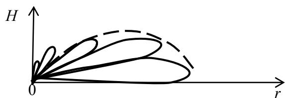
Рис. 3.27. Зона видимости РЛС в вертикальной плоскости
