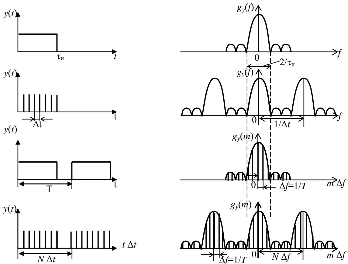
Рис. 4.119. Алгоритм ДПФ и эпюры, поясняющие вычисление сверточных сумм одиночного и периодического квантованных сигналов
