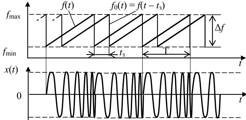
Рис. 4.56. Случай полной частотной демодуляции ЛЧМ-сигнала
