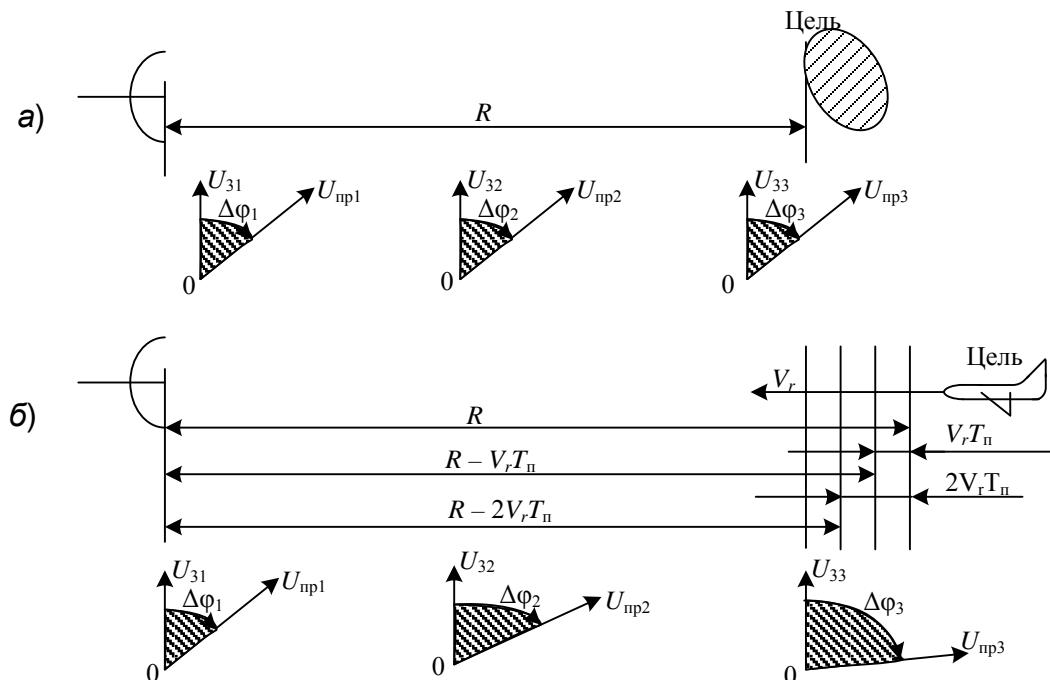
Рис. 4.81. Зависимость разности фаз от характера объекта:
