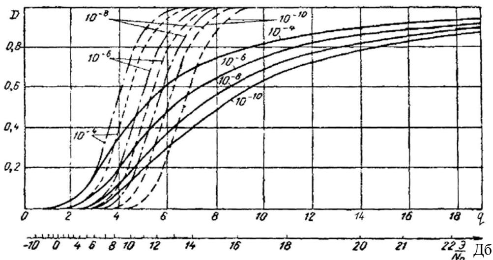
Рис. 3.11. Кривые обнаружения для сигналов: с полностью известными параметрами (штрих-пунктир), со случайной начальной фазой (пунктир), со случайными амплитудой и начальной фазой (сплошные линии)
