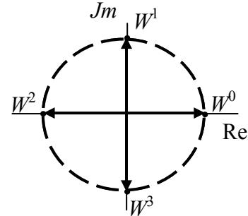
Точки  $W^i = e^{-j} \frac{\pi i}{2}$  находятся на этой окружности и представляют собой периодическую последовательность. Все  $i$ , лежащие в пределах от 0 до 3, полностью определяют любую степень при  $i \geq 4$ . Суммы вида (4.81) называют *свертками*. Свертки, обладающие описанным свойством, называются *круговыми*. С учетом отмеченного матрицу ДПФ можно записать в виде
