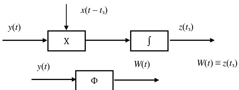
Рис. 4.11. К определению импульсной характеристики согласованного фильтра
