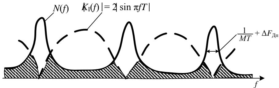
Рис. 4.96. Качество компенсации однократной схемой ЧПВ
