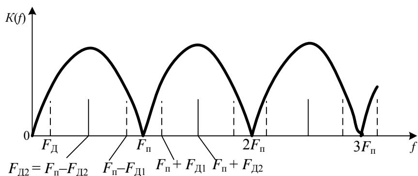
Рис. 4.95 Работа схемы однократного ЧПВ со спектральной точки зрения
