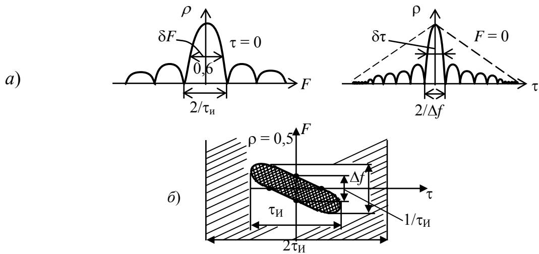
Рис. 5.19. Сечения тела неопределенности ЛЧМ-сигнала плоскостью  $F = \text{const}$  и  $\tau = \text{const}$  (а) и диаграмма неопределенности (б)
