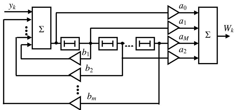
Рис. 4.117. Структурная схема БИХ-фильтра
