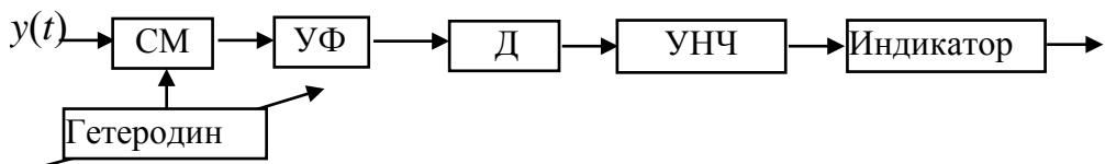
Рис .6.22. Одноканальный измеритель частоты последовательного обзора: УФ – узкополосный фильтр; СМ – смеситель; Д – детектор; УНЧ – усилитель низкой частоты
