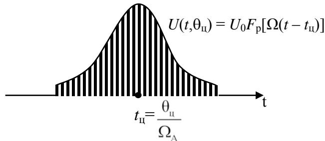
Рис. 6.31. Форма огибающей пачки импульсов на входе приёмника
