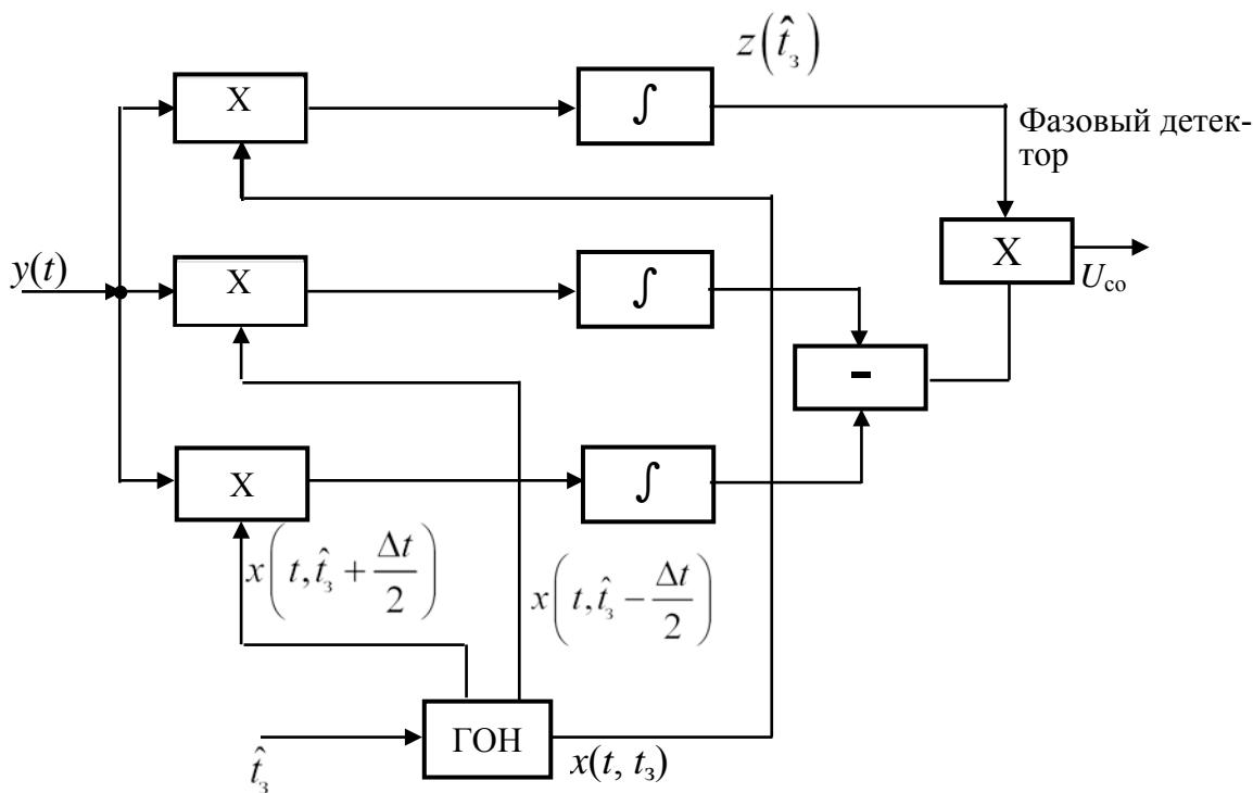
Рис. 6.18. Трехканальный следящий измеритель дальности
