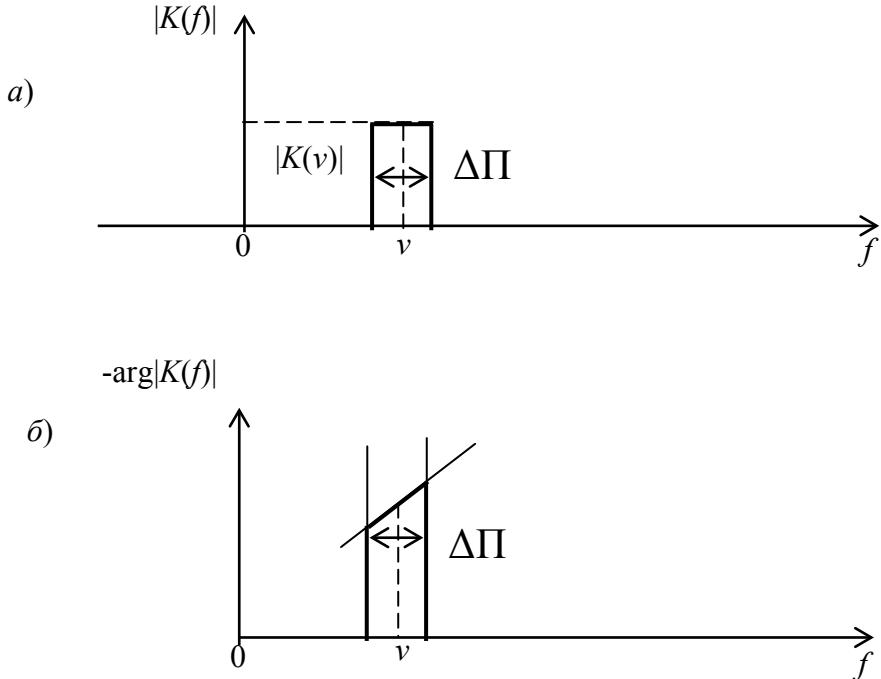
Рис. 4.44. Графики, поясняющие расчет:  $a$  – АЧХ фильтра,  $\delta$  – ФЧХ фильтра
