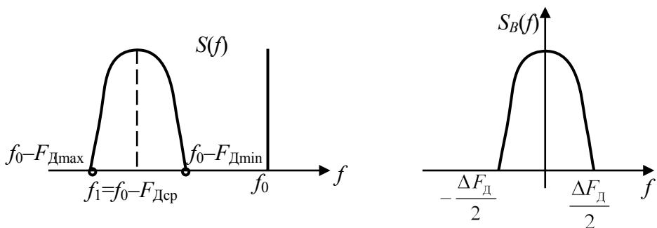
Рис. 2.25. Спектр флюктуаций при отражении сигнала от движущейся цели
