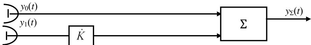
Рис. 4.109. Схема простейшего компенсатора помех
