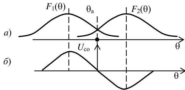
Рис. 6.34. Характеристики антенн  $F_1(\theta)$  и  $F_2(\theta)$  в прямоугольной системе координат (а), вид дискриминационной (пеленгационной) характеристики пеленгатора (б)
