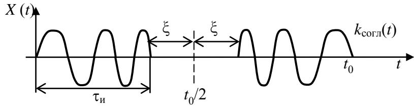
Рис. 4.12. Ожидаемый сигнал и его импульсная характеристика
