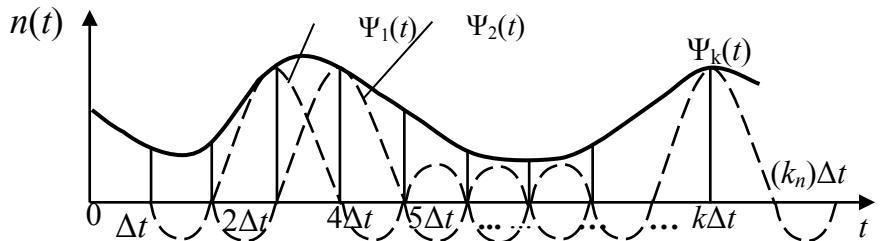
Рис. 2.32. Аппроксимация непрерывной функции  $n(t)$
