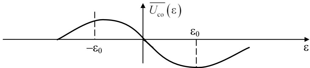
Рис. 6.8. Дискриминаторная характеристика
