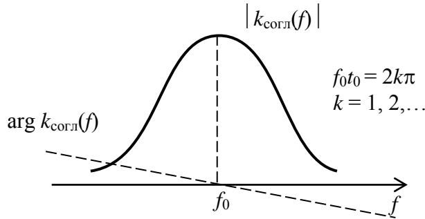
Рис. 4.21. Вид АЧХ и ФЧХ СФ гауссова радиоимпульса
