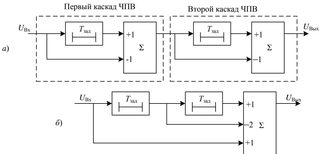
Рис. 4.97. Двукратные подавители помех на основе: *а* – каскадного включения простейших схем ЧПК; *б* – конического фильтра второго порядка
