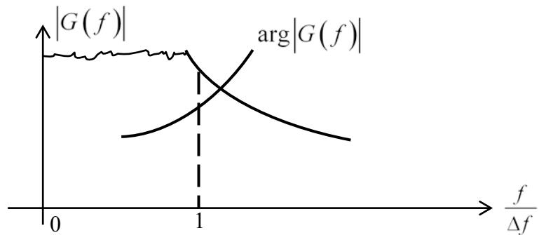
Рис. 4.46. АЧС и ФЧС комплексной амплитуды прямоугольного ЛЧМ-радиоимпульса при  $n = \tau_i \Delta f \gg 1$
