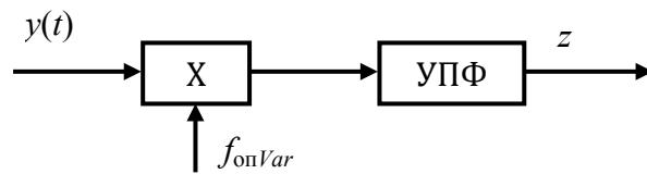
Рис. 4.8. Одноканальный коррелятор с последовательным обзором по скорости
