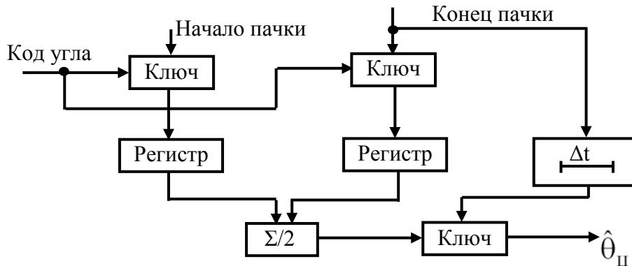
Рис. 6.32. Схема цифрового автомата оценки угловой координаты
