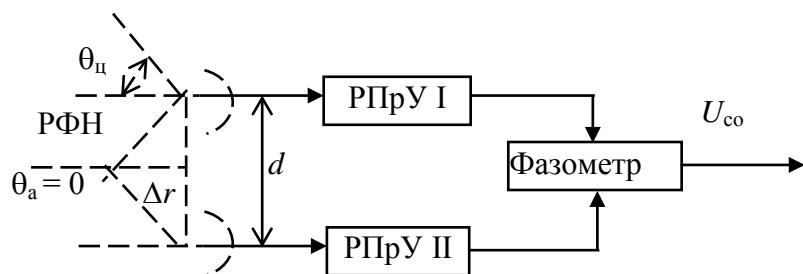
Рис. 6.39. Упрощенная схема фазового пеленгатора, реализующая метод ФМС
