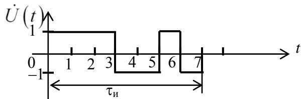
Рис. 5.22. Условное изображение комплексной амплитуды семиэлементного кода Баркера
