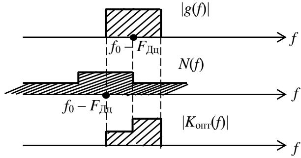
Рис. 4.70. Пояснение принципа режекции сигнала помехи
