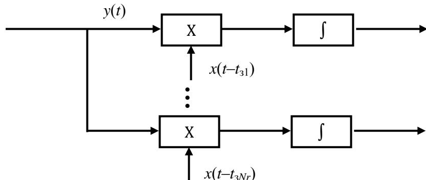
Рис. 4.7. Многоканальный коррелятор с параллельным обзором по дальности
