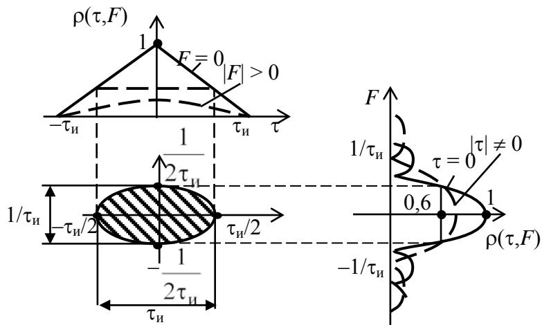
Рис. 5.11. Сечения тела неопределенности одиночного прямоугольного радиоимпульса (ОПРИ) плоскостями  $\tau, F = \text{const}$  и  $\rho = 0,5$
