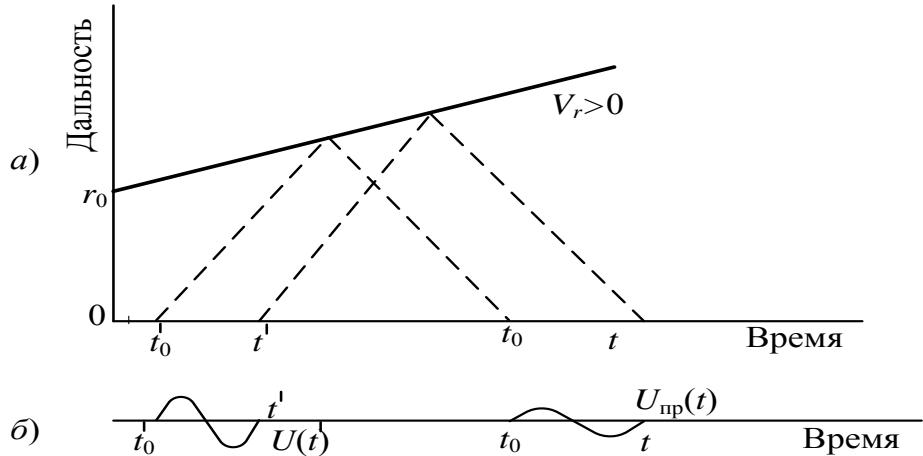
Рис. 4.61. Графики, поясняющие трансформацию сигнала, отраженного движущейся «блестящей» точкой
