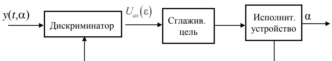
Рис. 6.7. Контур автоматического управления
