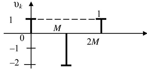
При этом  $|k(z)| = |1 - 2z^{-M} + z^{-2M}| = |1 - z^{-M}|^2$  и  $|k| = 4\sin^2 \pi f \tau$ , что соответствует двукратной схеме ЧПВ в цифровой системе СДЦ.
