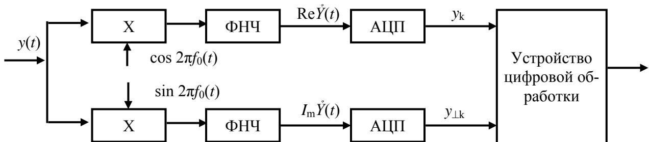
Рис.4.112. Схема цифровой обработки на видеочастоте
