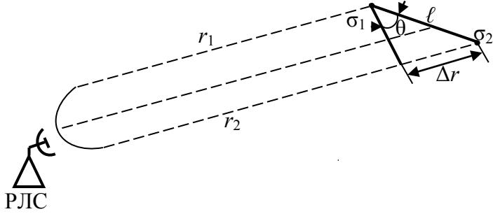
Рис. 2.21. К определению ЭПР простейшего группового излучателя
