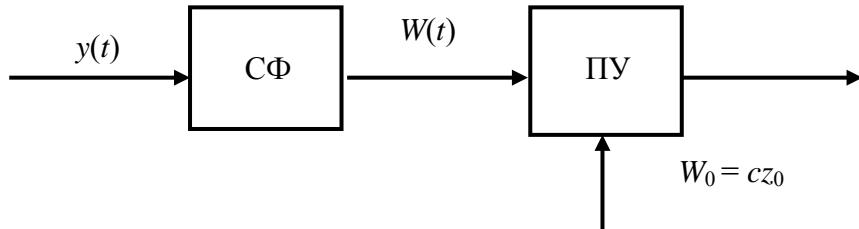
Рис. 4.17. Фильтровый обнаружитель для сигнала с полностью известными параметрами
