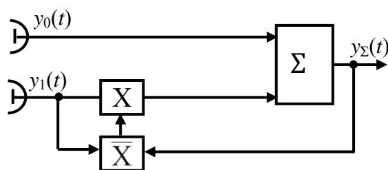
Рис. 4.111. Схема простейшего корреляционного автокомпенсатора
