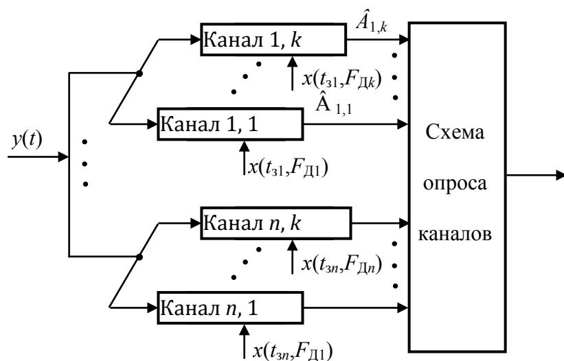
Рис. 4.10. Многоканальный корреляционный обнаружитель
