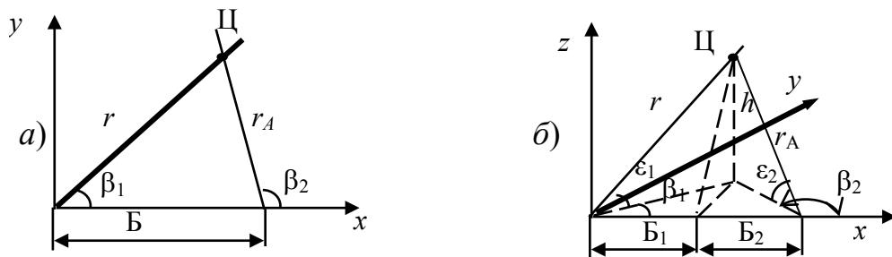
Рис. 7.4. Пояснение триангуляционного метода определения координат на плоскости ( $a$ ) и в пространстве ( $b$ ).
