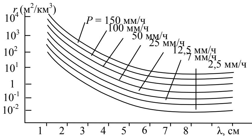
Рис. 4.66. График зависимости удельной эффективной площади обратного вторичного излучения дождя различной интенсивности от длины волны ( $P$  – обозначает интенсивность осадков)
