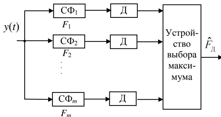
Рис. 6.20. Структурная схема оптимального измерителя частоты Доплера
