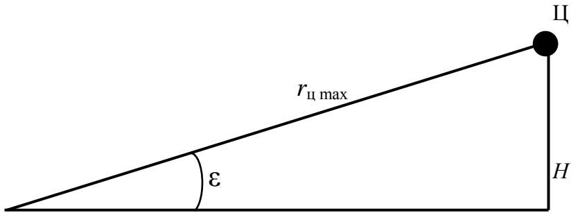
Рис. 3.29. Расчет угла места цели
