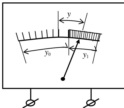
Рис. 3.2. Обнаружение сигнала по показанию стрелочного прибора
