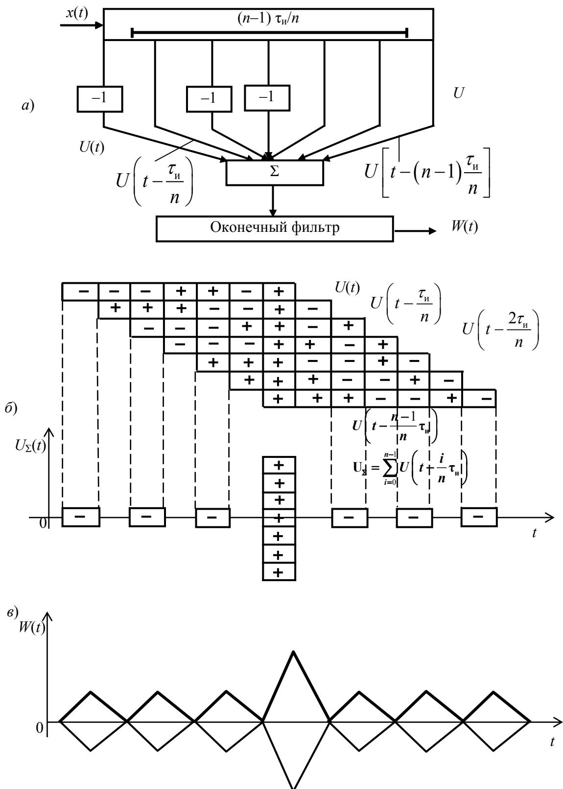
Рис.4.40. Процесс оптимальной фильтрации ФМ-сигнала:
