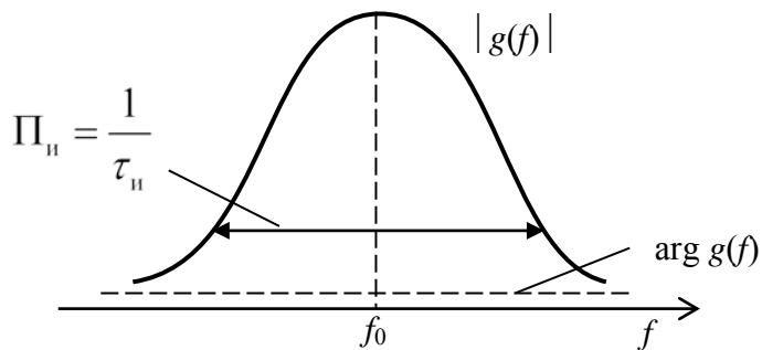
Рис. 4.20. Спектр гауссова радиоимпульса
