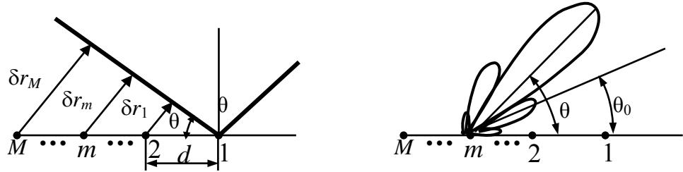
Рис. 5.28. К определению пространственной АКФ эквидистантной антенной решетки
