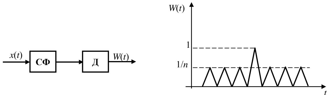
Рис. 4.35. Согласованный фильтр ФМ-сигнала и вид сигнала на его выходе
