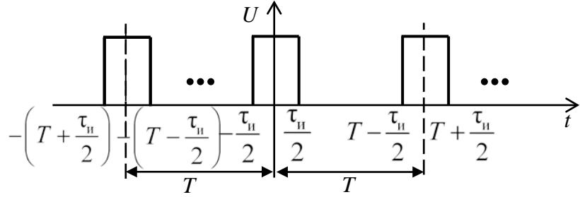
Рис. 5.14. Вид огибающей сигнала в виде прямоугольной когерентной пачки прямоугольных радиоимпульсов
