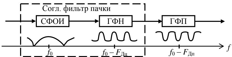
Рис. 4.72. Схема оптимальной обработки пачки когерентных радиоимпульсов на фоне белого шума
