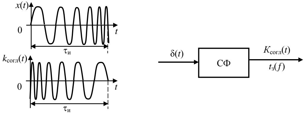
Рис. 4.42. Вид ЛЧМ-радиоимпульса и соответствующая ему импульсная характеристика
