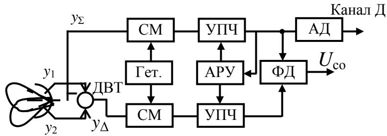
Рис. 6.36. Структурная схема системы АМС с суммарно-разностной обработкой
