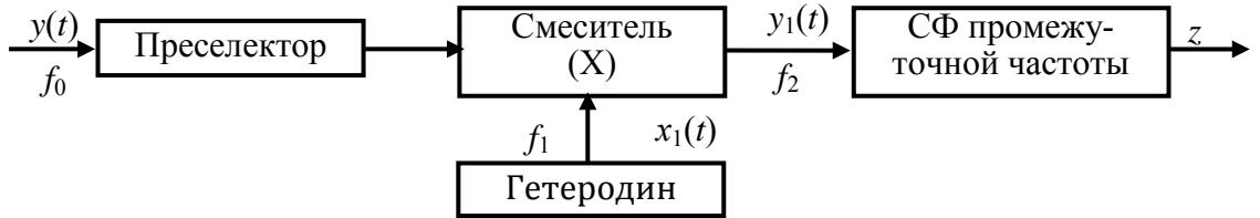
Рис. 4.55. Схема корреляционно-фильтрового обнаружителя на промежуточной частоте
