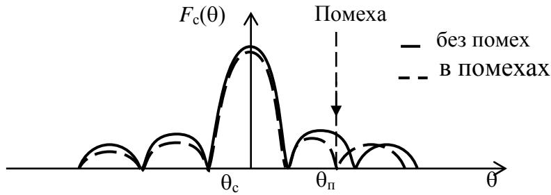
Рис. 4.107. Компенсация коррелированных по элементам антенны помех за счет образования провалов
