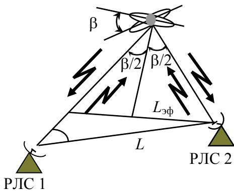
Рис. 7.2. Иллюстрация возможности увеличения точности измерения координат цели в МП РЛС
