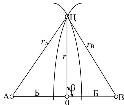
Рис. 7.6. Пояснение угломерно-разностно- дальномерного метода определения координат на плоскости
