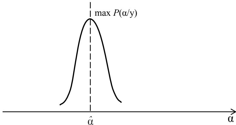
Рис. 6.4. Получение оптимальной оценки параметра  $\alpha$  по максимуму  $P(\alpha/y)$
