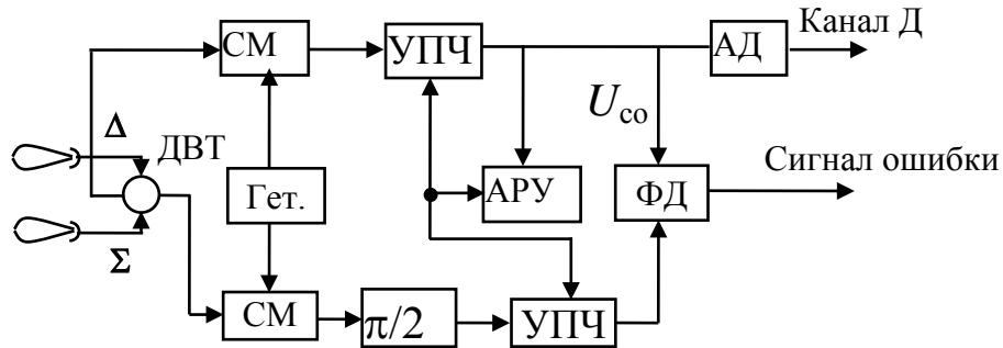
Рис. 6.43. Структурная схема следящего измерителя с суммарно-разностной обработкой
