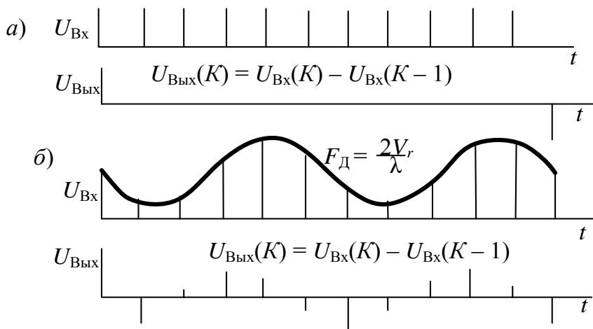
Рис. 4.94. Сигналы на выходе простейшей схемы ЧПК при отражении от цели:
