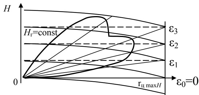
Рис. 3.28. Построение зоны видимости РЛС в вертикальной плоскости
