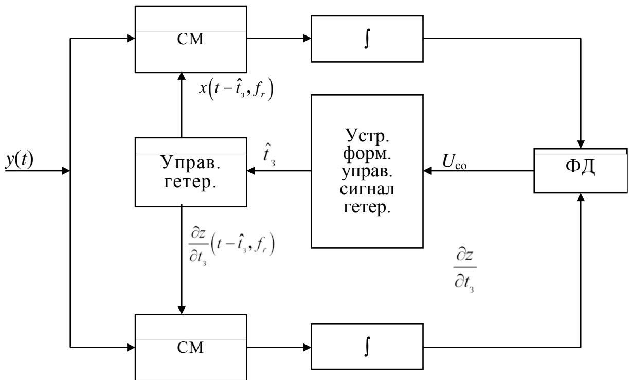
Рис 6.17. Схема двухканального следящего измерителя дальности
