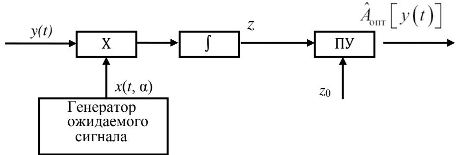
Рис. 4.1. Простейший корреляционный обнаружитель
