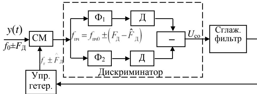
Рис. 6.23. Структурная схема следящего измерителя частоты на основе частотного дискриминатора с двумя расстроенными по частоте каналами
