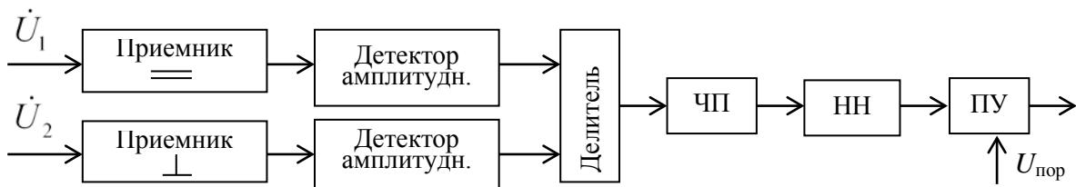
Рис. 6.53. Устройство распознавания по амплитудным элементам поляризационной матрицы рассеяния
