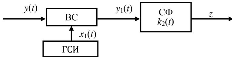
Рис. 4.53. Схема корреляционно-фильтрового обнаружителя когерентной пачки радиоимпульсов со стробированием: ВС – временной селектор; ГСИ – генератор стробирующих импульсов; СФ – согласованный фильтр
