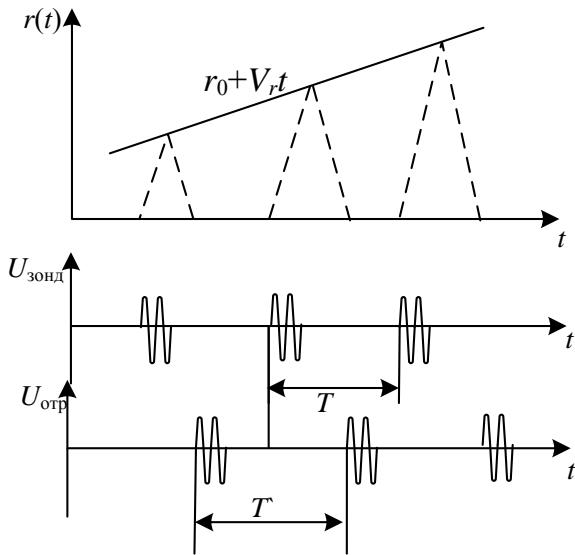
Рис. 4.62. Пояснение трансформации периодической последовательности радиоимпульсов, отраженных движущейся «блестящей» точкой
