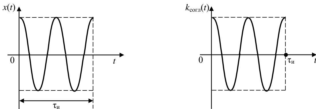
Рис. 4.22. Прямоугольный радиоимпульс и его импульсная характеристика
