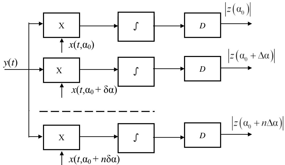
Рис. 6.5. Неследящий измеритель на основе корреляционно-фильтрового приемника
