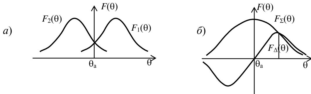
Рис. 6.37. Диаграммы направленности каналов системы АМС (а) для рис. 6.36, суммарная  $F_\Sigma(\theta)$  и разностная  $F_\Delta(\theta)$  диаграммы (б)
