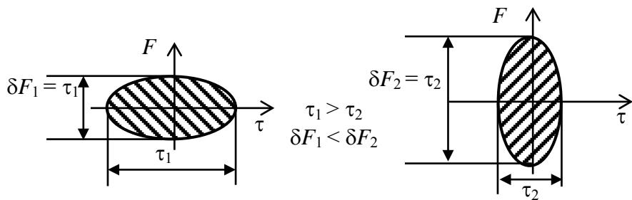
Рис. 5.13. Диаграммы неопределенности одиночного прямоугольного радиоимпульса для различных значений  $\tau, F$
