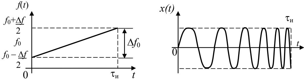
Рис. 2.8. Прямоугольный ЛЧМ-радиоимпульс
