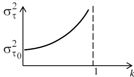
Рис. 6.27. Зависимость дисперсии ошибок совместного измерения времени запаздывания и частоты от коэффициента корреляции
