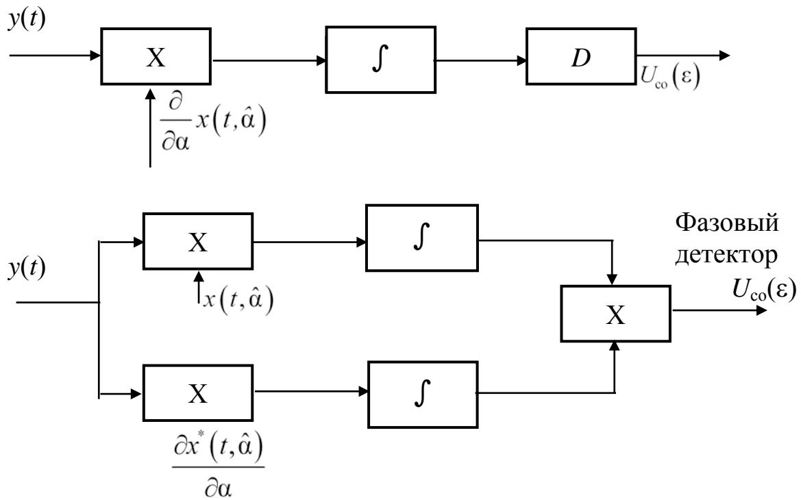
Рис. 6.6. Схемы дискриминаторов для получения оптимальных оценок изменяющихся параметров
