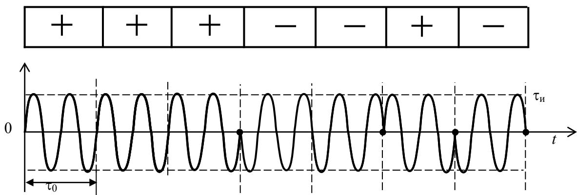
Рис. 2.11. ФКМ-радиоимпульс для семиразрядного кода Баркера
