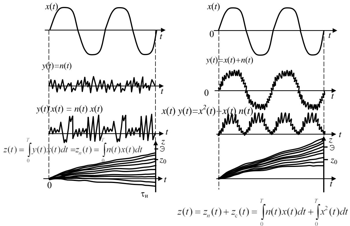
Рис. 4.3. Эпюры, поясняющие принцип работы корреляционного обнаружителя
