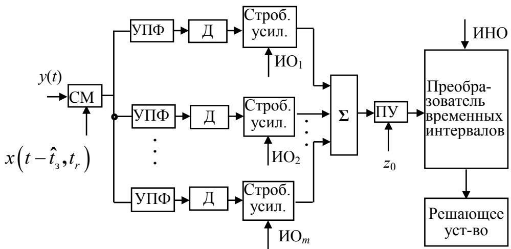
Рис. 6.21. Структурная схема простейшего неследящего измерителя доплеровского сдвига частоты при КФО когерентной пачки радиоимпульсов
