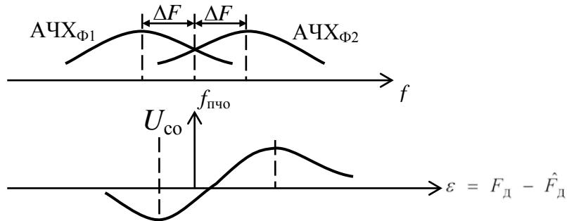
Рис. 6.24. Зависимость сигнала ошибки  $U_{\text{co}}$  от частоты  $F_d$
