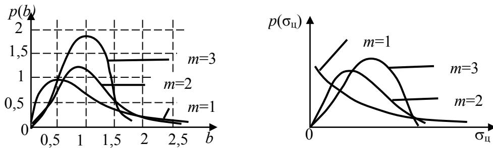
Рис. 2.24. Законы распределения флюктуаций амплитуд отраженного сигнала  $p(b)$  и ЭПР цели  $p(\sigma_u)$
