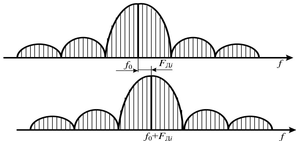
Рис. 4.63. Сдвиг спектра частот импульсов отраженных колебаний на доплеровскую добавку
