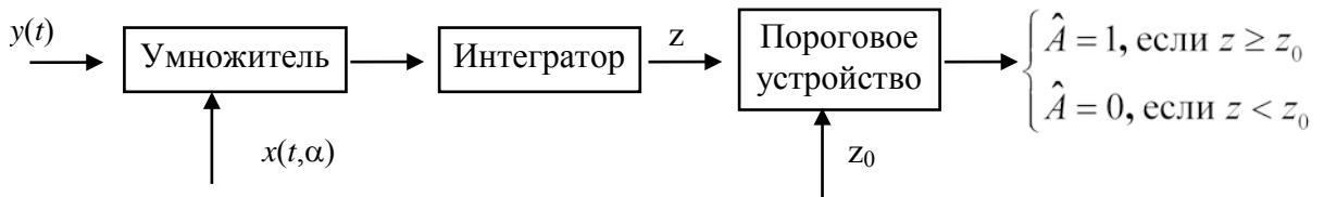
Рис. 3.5. Структурная схема корреляционного обнаружителя сигнала с полностью известными параметрами
