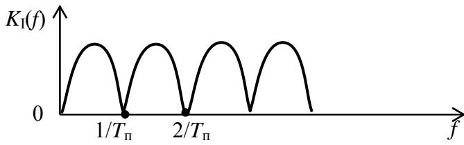
Рис. 4.76. АЧХ однократной схемы ЧПВ
