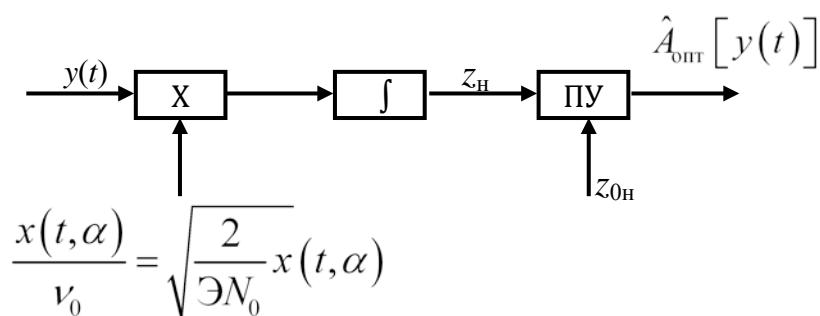
Рис. 4.2. Схема корреляционного обнаружителя с нормированным порогом
