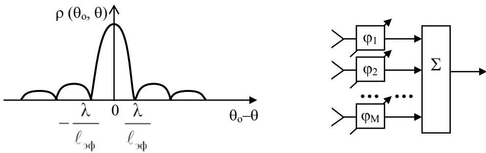
Рис. 5.29. Нормированная ДН по полю АР при равномерном амплитудном и линейном фазовом распределении токов на апертуре
