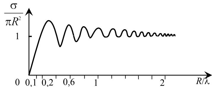
Рис. 2.19. Зависимость ЭПР шара от отношения  $R/\lambda$
