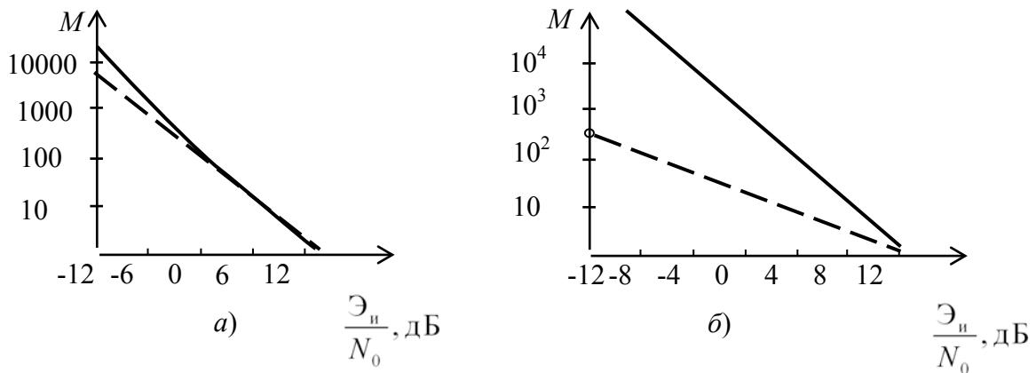
Рис. 3.15. Кривые для оценки выигрыша некогерентного суммирования нефлюктуирующей пачки с прямоугольной огибающей: (сплошная линия – для линейного, пунктирная – для квадратичного суммирования);  $a$  – для  $D = 0,5, F = 10^{-10}$ ;  $b$  – для  $D = 0,9$  и  $F = 10^{-7}$
