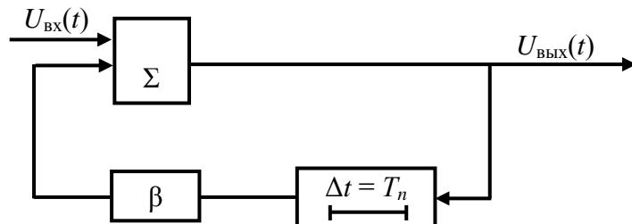
Рис. 4.78. ГФН на основе рециркулятора
