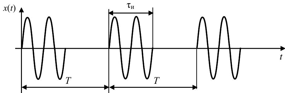
Рис. 4.26. Пачка простых прямоугольных радиоимпульсов
