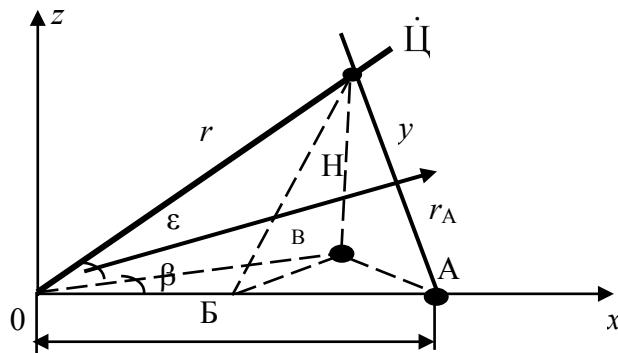
Рис. 7.8. Пояснение угломерно-разностно-дальномерного метода определения координат в пространстве
