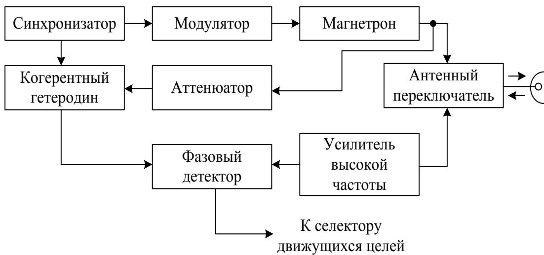
Рис. 4.82. Структурная схема простейшей псевдокогерентной РЛС
