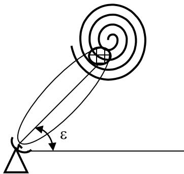
Рис. 1.6. Последовательный спиральный обзор с ДН игольчатого типа
