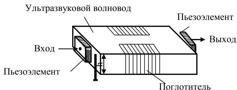
Рис. 4.51. Фильтр сжатия на основе ультразвукового волновода
