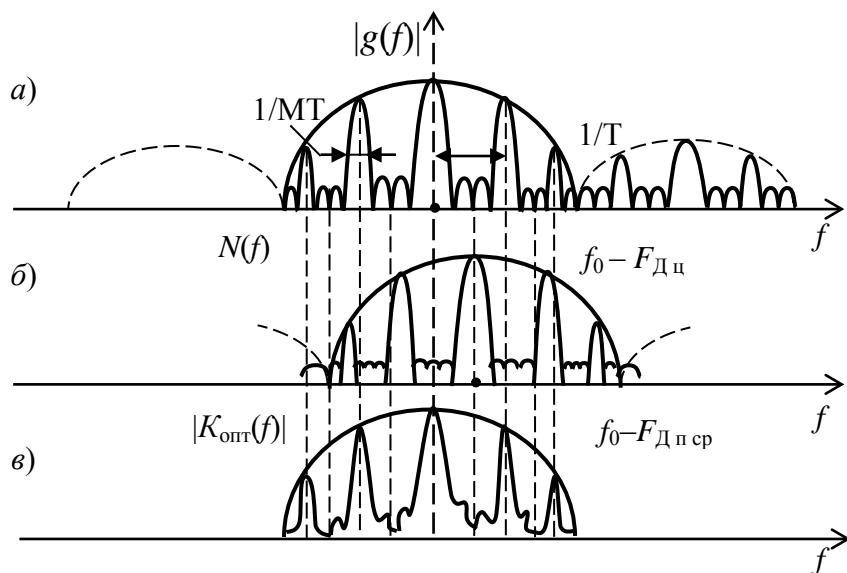
Рис. 4.71. Эпюры, иллюстрирующие вид: *а* – АЧС полезного сигнала (когерентная пачка); *б* – спектр ПП; *в* – АЧХ оптимального фильтра
