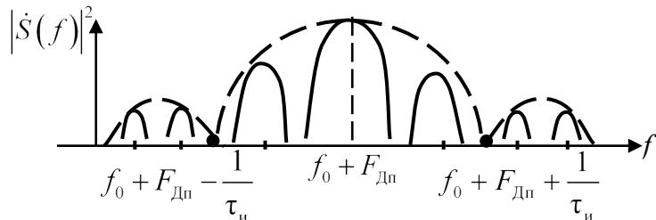
Рис. 2.34. Энергетический спектр одиночного зондирующего сигнала
