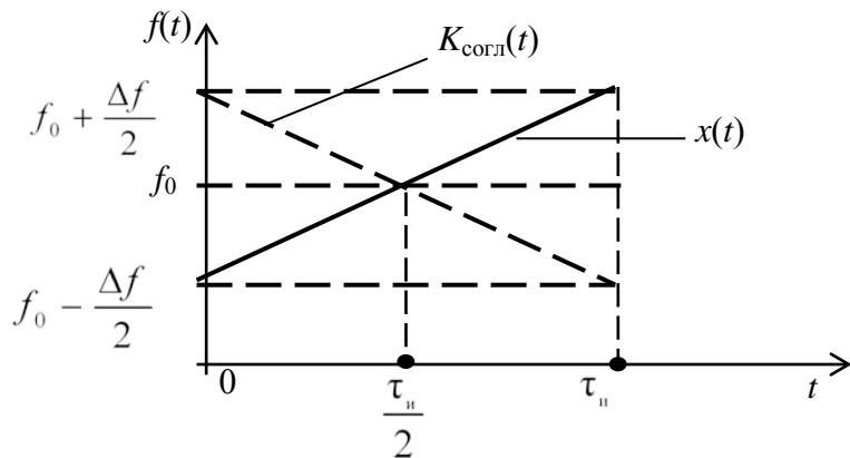
Рис. 4.41. Закон изменения мгновенной частоты
