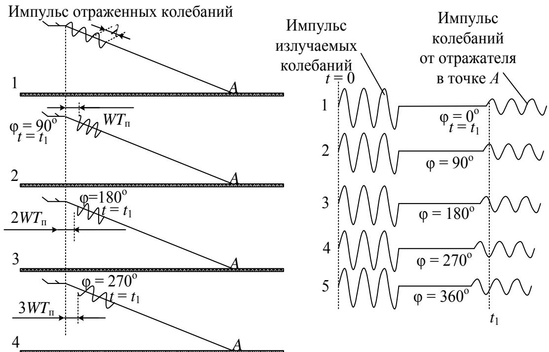
Рис. 4.64. Изменение фазы колебаний от отражателя в точке  $A$  от одного периода повторения импульсов к другому
